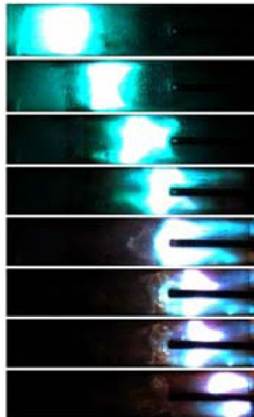
Obr. 14 Vznik a vstup oblouku do zhášecího roštu
