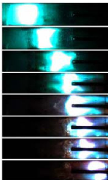
Obr. 14 Vznik a vstup oblouku do zhašecího roštu
