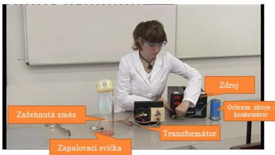
Obr. 4: Model doplněný o elektrickou zapalovací svíčku (foto autoři)
