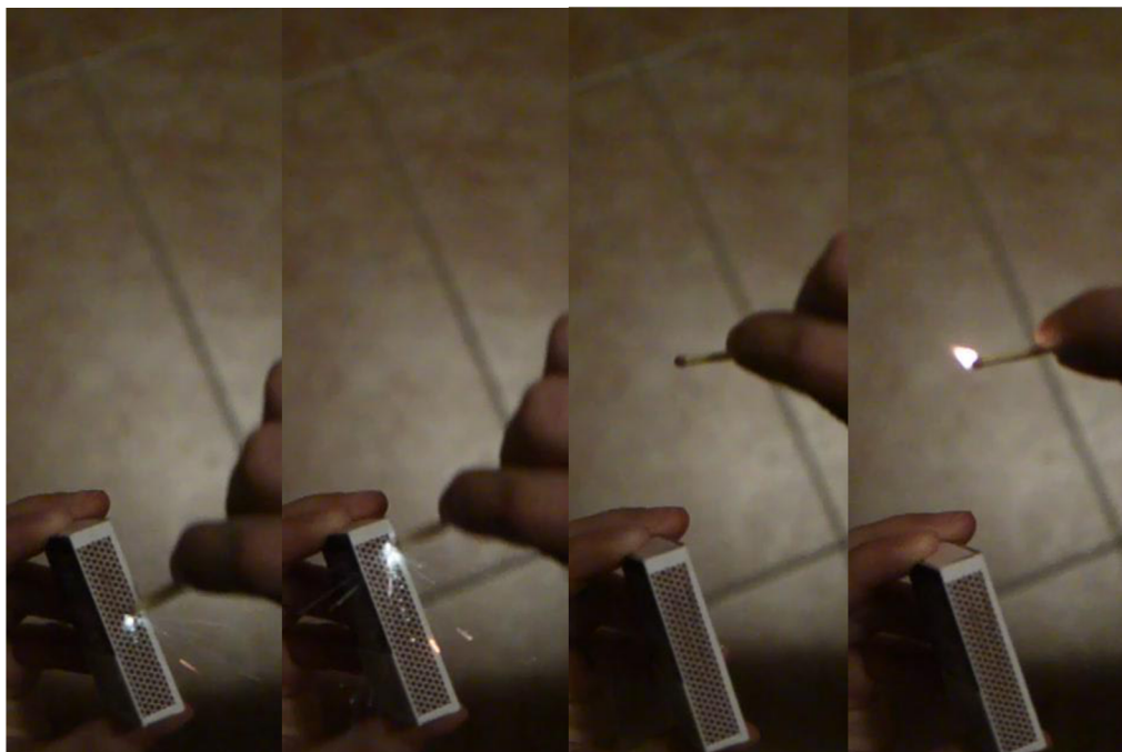
Obr. 16: Tření hlavičky zápalky o škrťátko a vzplanutí zápalky (foto žáci)
