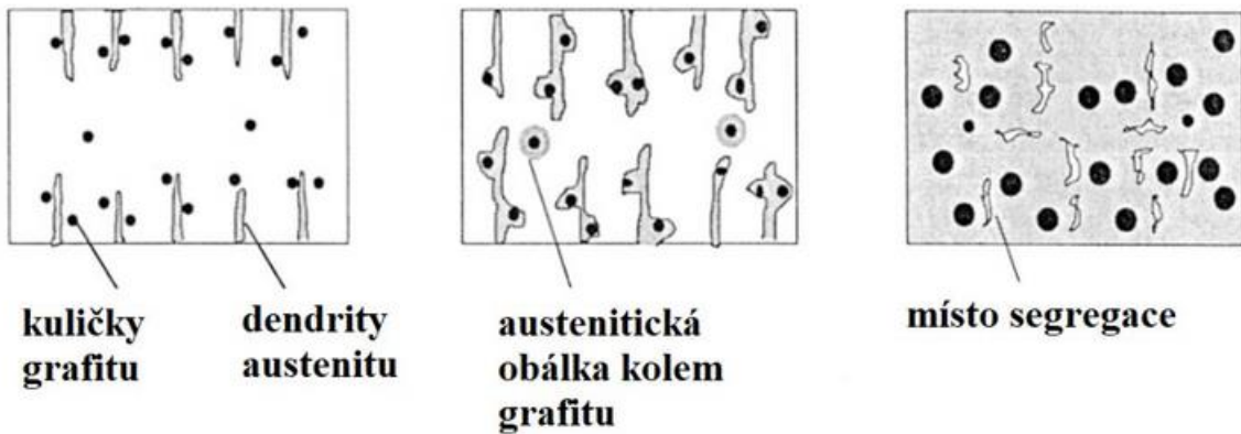
Obr. 1: Schéma tuhnutí tenkostěnných odlitků z LKG [1].
