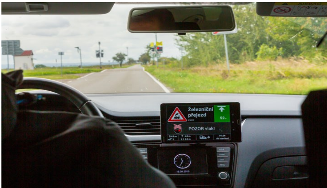
Obr. 2.17 Zobrazení přijímaných informací na displeji ve vozidle, C-ROADS – poznatky z testovacích provozů
