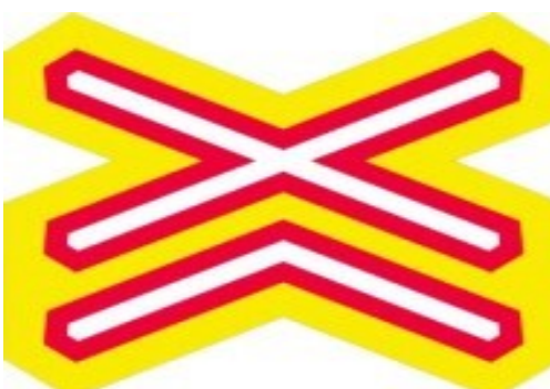
Obr. 2.4 Výstražný kříž pro železniční přejezd vícekolejný A32b
