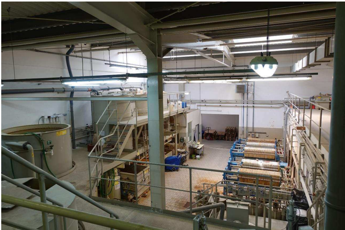
Příloha č. 6: Neutralizační stanice v provozovně PRYM CONSUMER CZ s.r.o. (zdroj: zpracovatel)
