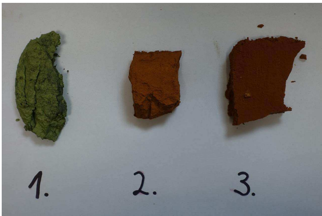
Příloha č. 14: Kaly produkované neutralizační stanicí v provozovně PRYM CONSUMER CZ s.r.o. (1) kal z procesu pasivace, (2) kal z procesu chemického odhroťování (3) kal z kyselých a alkalických odpadních vod (zdroj: zpracovatel)
