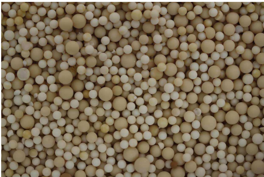
Příloha č. 10: Fotografie ionexu Lewatit TP 207 před regenerací, velikost částic od 210 \mu\text{m} do 1213 \mu\text{m} (zdroj: zpracovatel).
