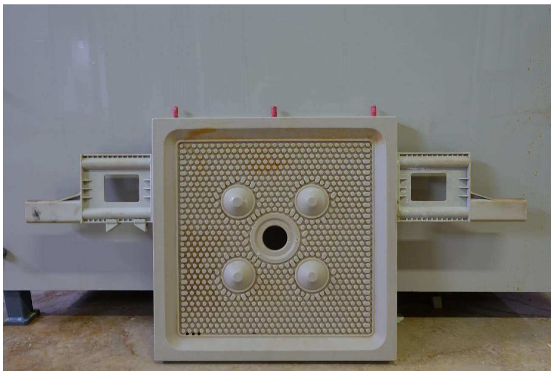
Příloha č. 15: Rámeček z kalolisu používaný v provozovně PRYM CONSUMER CZ s.r.o. (zdroj: zpracovatel)
