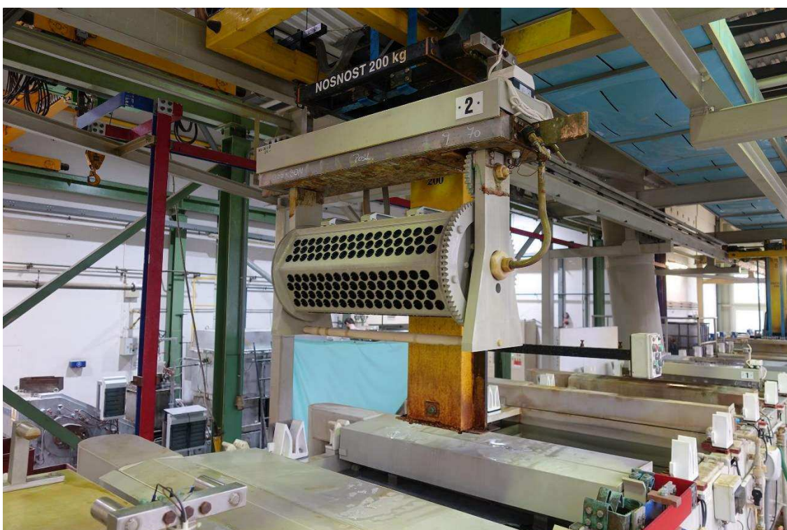
Příloha č. 3: Galvanický buben (materiál PP) používaný v provozovně PRYM CONSUMER CZ s.r.o. (zdroj: zpracovatel)
