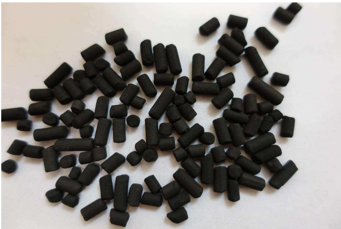
Příloha č. 9: Granule aktivního uhlí AK 3072 M používané v provozovně PRYM CONSUMER CZ s.r.o. (zdroj: zpracovatel)
