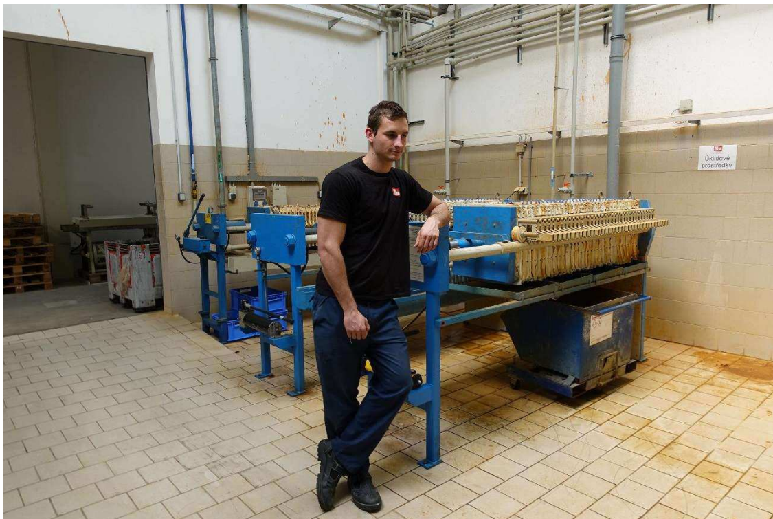
Příloha č. 17: Kalolisy používané v provozovně PRYM CONSUMER CZ s.r.o. (zdroj: zpracovatel)
