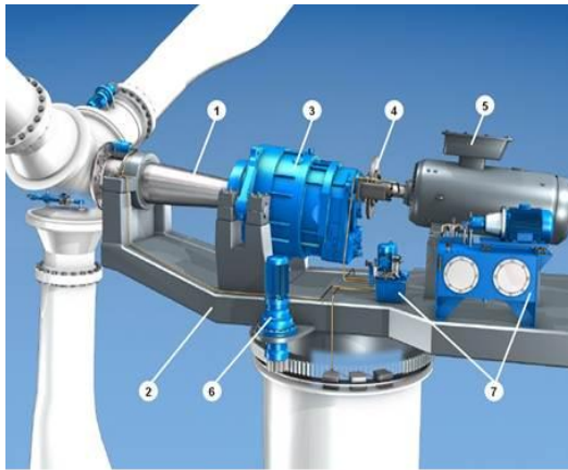
Obr. 6: Strojovna větrné elektrárny
