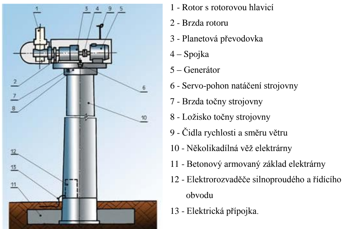
Obr. 5: Schéma větrné elektrárny
