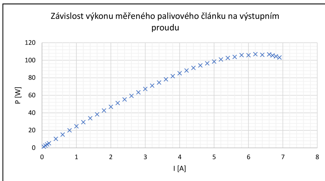
Obrázek 5.20 Závislost výkonu měřeného palivového článku na výstupním proudu
