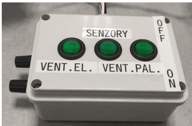
Obrázek 5.3 Blok spínačů pro ovládání systému
