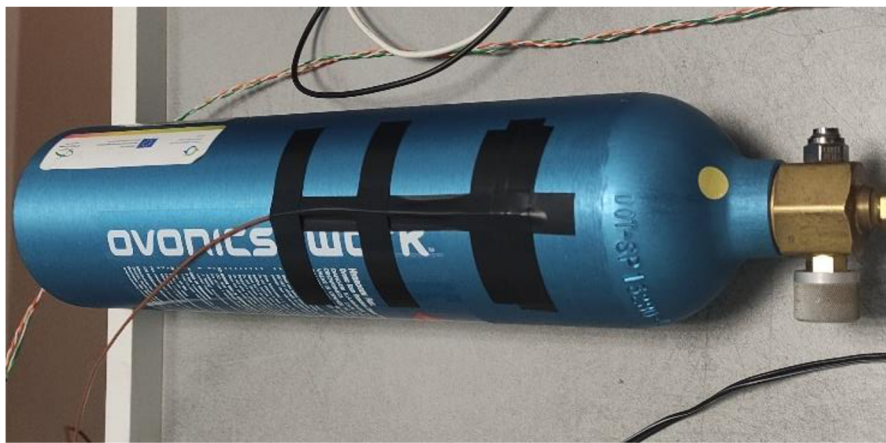
Obrázek 5.9 Metalhydridové úložiště HS760
