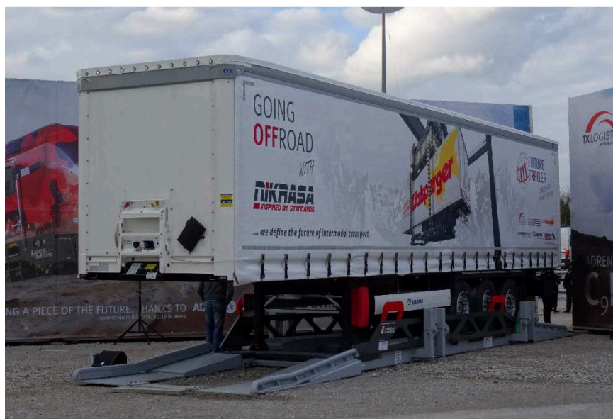
Obr. 10: Návěs uložený v manipulačním rámu (NiKRASA) Zdroj: Autor
