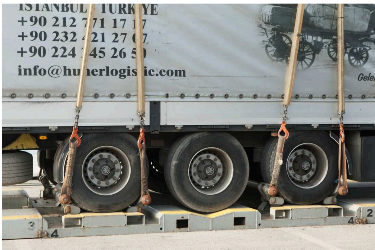
Obrázek 11: Překládka silničního návěsu systémem ISU
