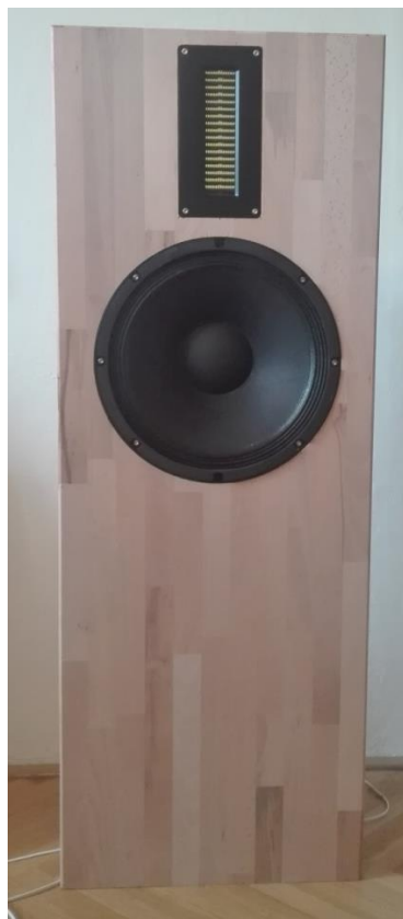
Obrázek 3-17 Fotografie prototypu otevřené ozvučnice osazená reproduktory
