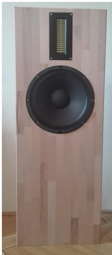
Obrázek 3-17 Fotografie prototypu otevřené ozvučnice osazená reproduktory
