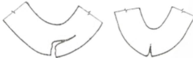
Obr. 26: Porušení materiálu při ohýbání [14].
