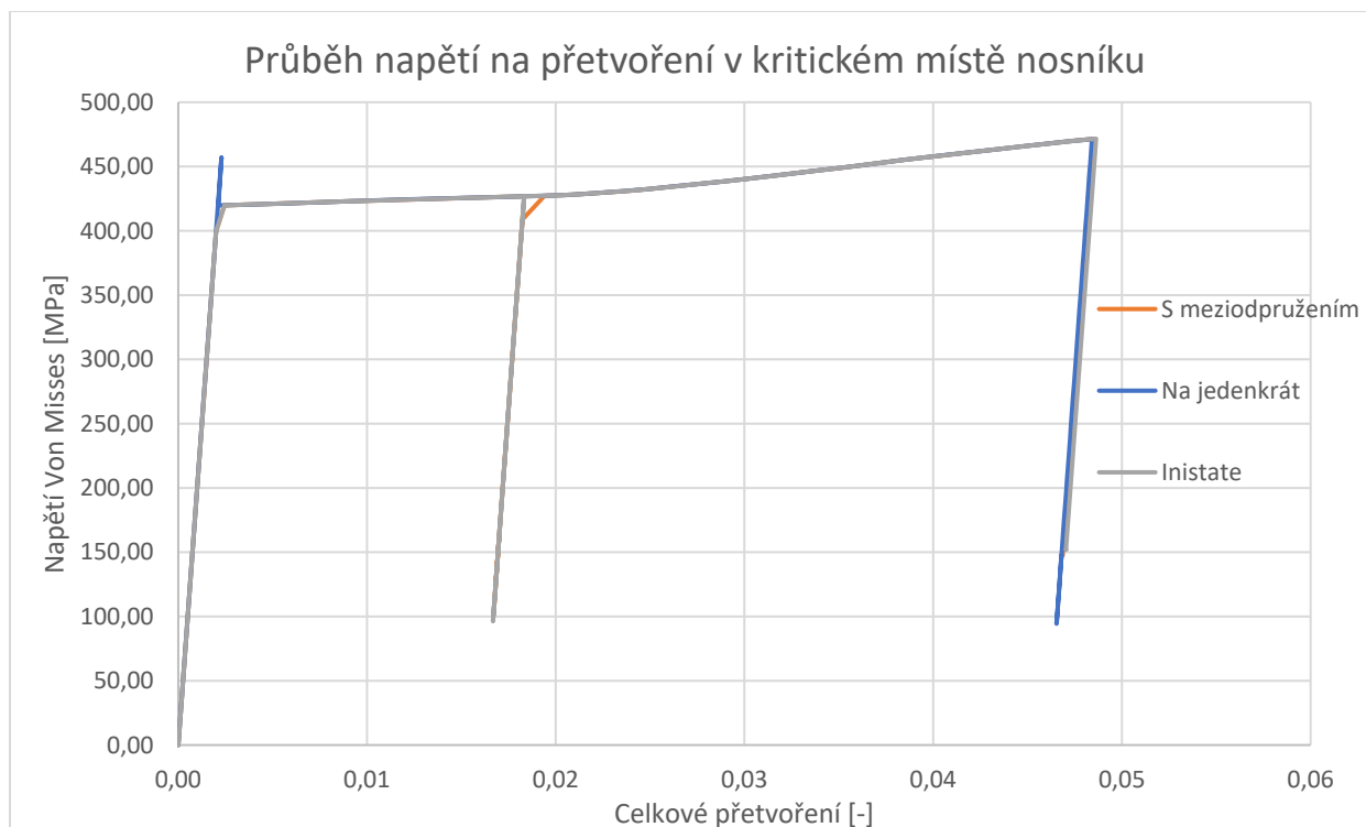
Graf 1: Průběh napětí na přetvoření v kritickém místě nosníku.
