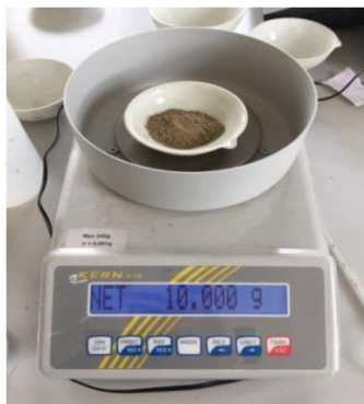
Obrázek 13 Vážení vzorků půdy na váze s přesností 0,001g (vlastní foto)
