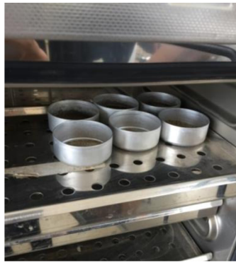
Obrázek 12 Váženky v sušicí komoře (vlastní foto)
