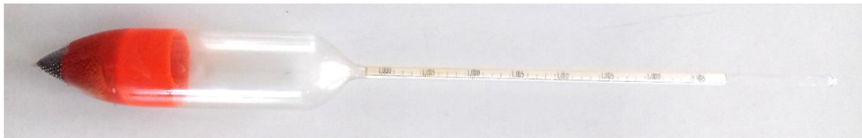
Obrázek 8 Hustoměr (vlastní foto)
