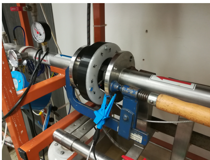
Obrázek 6.10: Finální prototyp průtokoměru s Halbachovou soustavou magnetů
