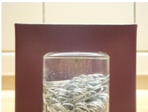
obr. 11 - Díky povrchovému napětí vody, tvoří hladina malý kopec.
