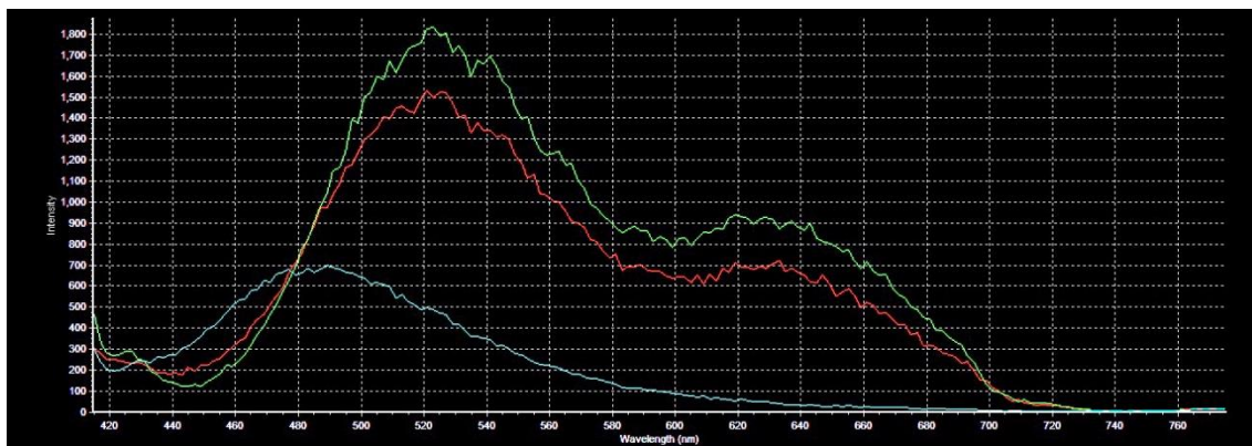
Obr. 7: Charakterizace emisního spektra (tzv. Lambda scan). Lambda skenování bylo provedeno pomocí 5 nm spektrálního okna, posunovaného souvisle přes spektrum v rozmezí 415-780 nm, ve 181 krocích, každý krok byl v šíři 2 nm. Červená křivka znázorňuje spektrum bodu 1 (léze; viz Obr. 6) a bodu 2 (léze) s lokálními fluorescenčními maximy 520 nm a 640 nm. Modrá křivka znázorňuje spektrum bodu 3 (zdravé křídlo) s fluorescenčním maximem 490 nm. Emisní spektrum bylo pořízeno ve spolupráci s Centrem cytometrie a mikroskopie, MBÚ AV ČR.
