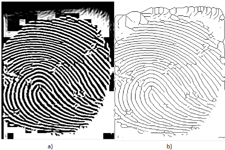
obrázek 3.3 a) obrázek otisku po filtraci Gáborovými filtry, b) obrázek otisku po ztenčení papilárních linií
