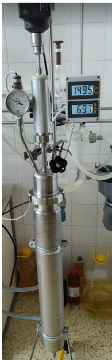
Obrázek č.15: Reaktor využitý pro alkoholýzu P3HB ethanolem
