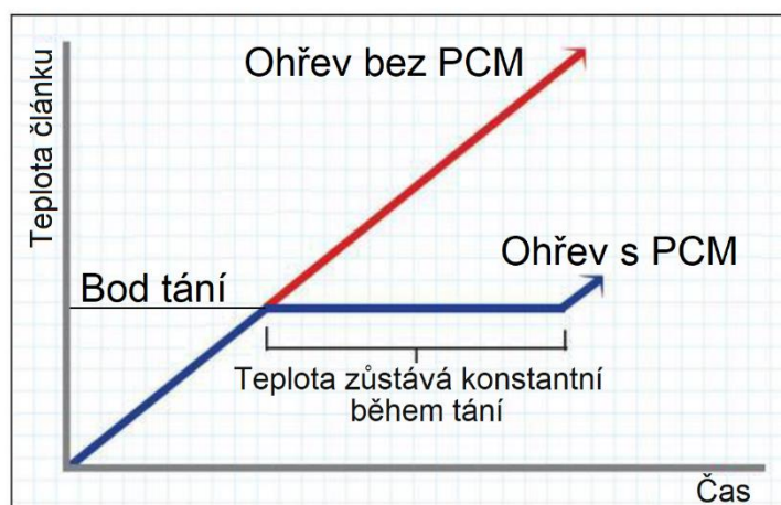
Obr. 42 Vliv PCM na teplotu článku [102] (upravené)
