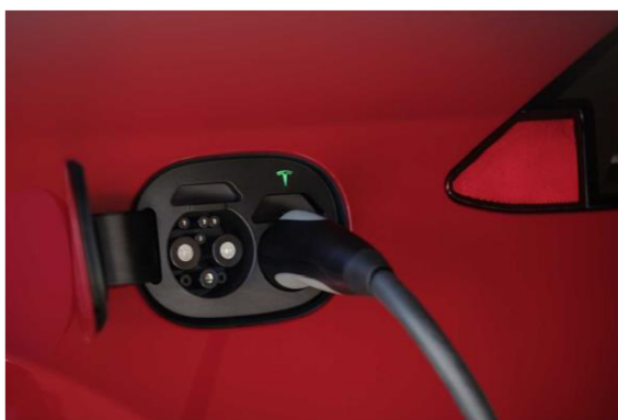
Obr. 25 Tesla model 3 s GB/T konektorem [61]
