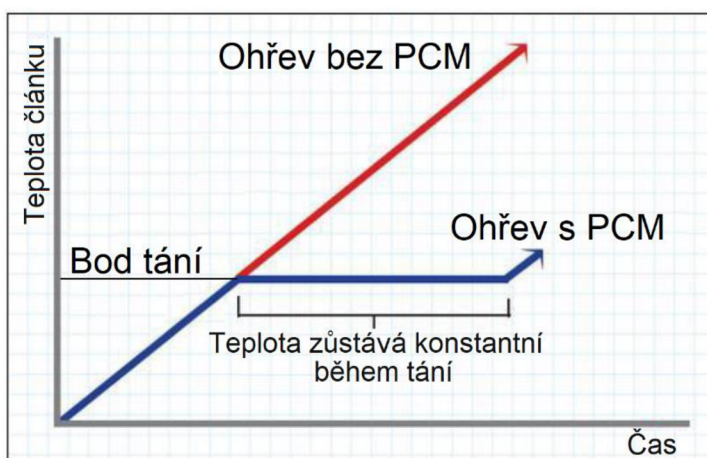
Obr. 42 Vliv PCM na teplotu článku [102] (upravené)
