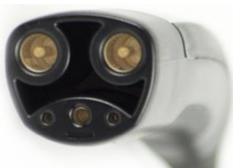
Obr. 8 Tesla U.S. konektor [22]
