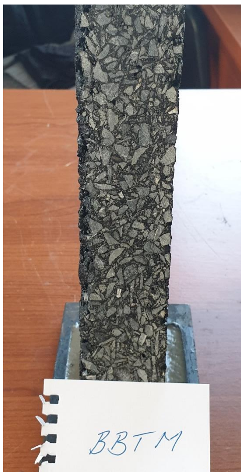
Obrázek 30: Pohled na řez deskou směsi BBTM 8 NH (30)
