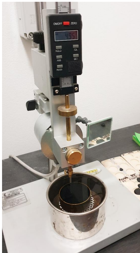
Obrázek 14: Provádění zkoušky penetrace jehlou (30)
