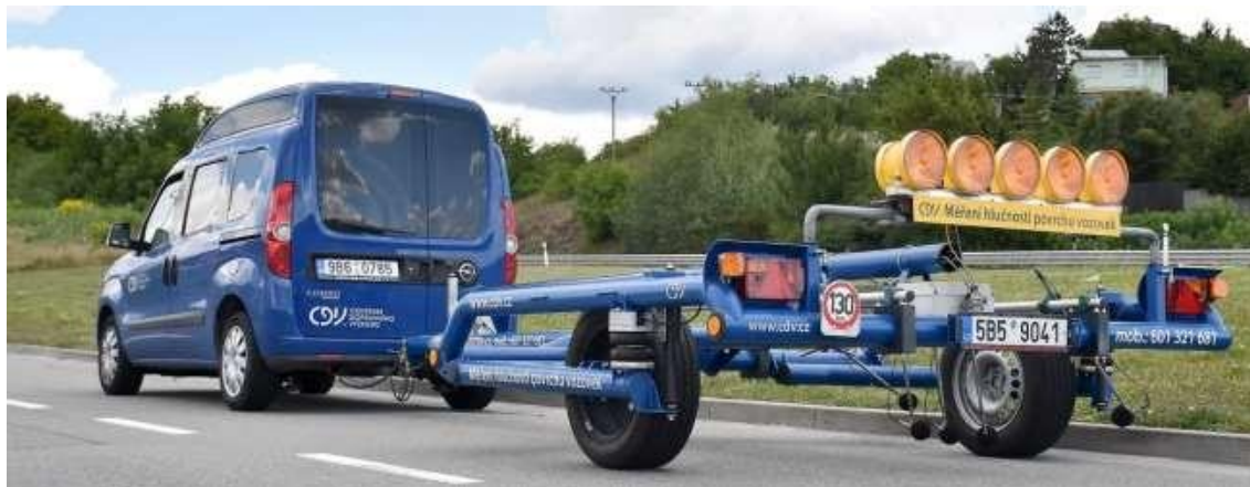
Obrázek 7: Měřicí přívěs CPX (12)
