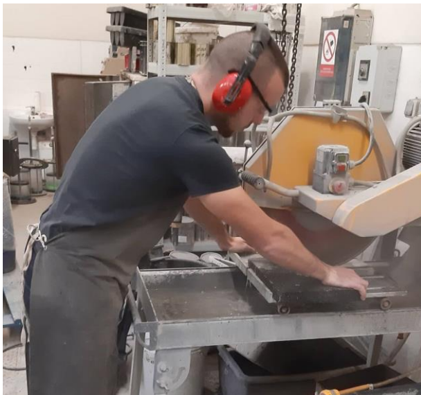
Obrázek 37: Vyřezávání zkušebních těles (30)
