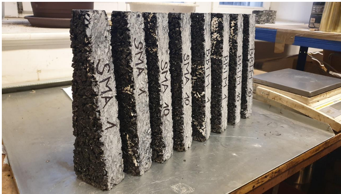
Obrázek 39: Pohled na nařezaná zkušební tělesa (30)
