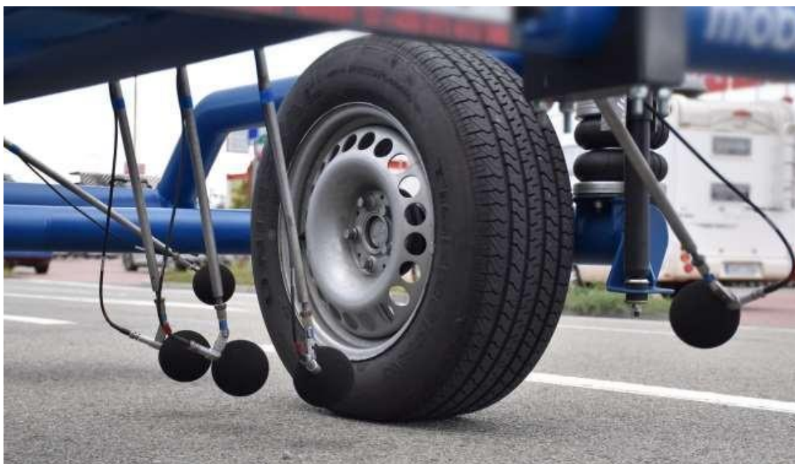
Obrázek 6: Umístění mikrofonů kolem referenční pneumatiky (12)
