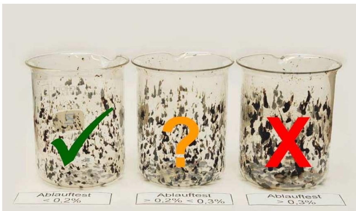
Obrázek 3: Zkouška stékavosti pojiva (8)
