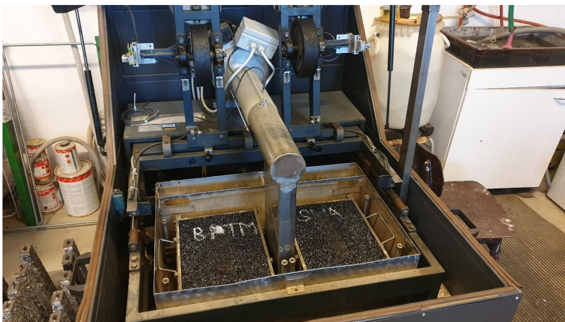
Obrázek 35: Pohled na zkušební tělesa po zkoušce poježdění kolem (30)
