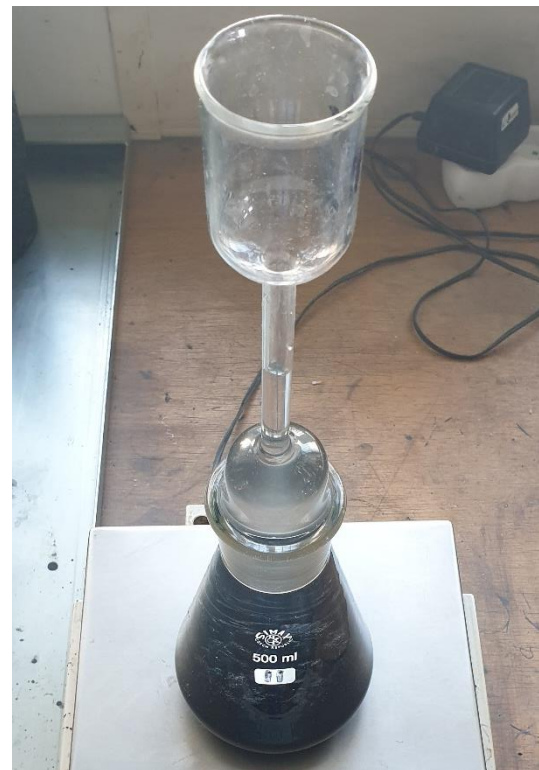
Obrázek 24: Vážení pyknometru se směsí, nástavcem a doplněnou vodou po rysku (30)
