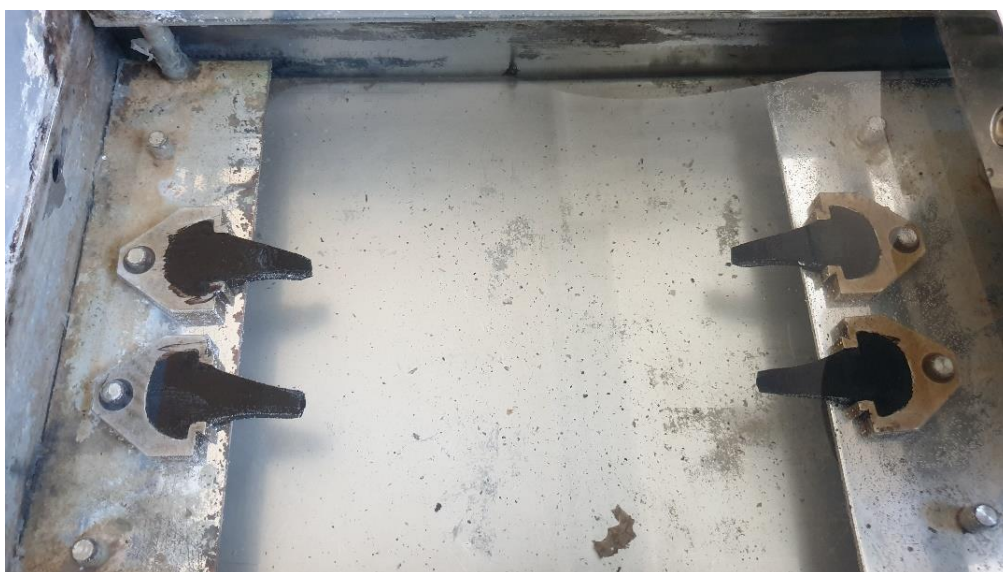
Obrázek 118: Provedení zkoušky vratné duktility 2 (30)
