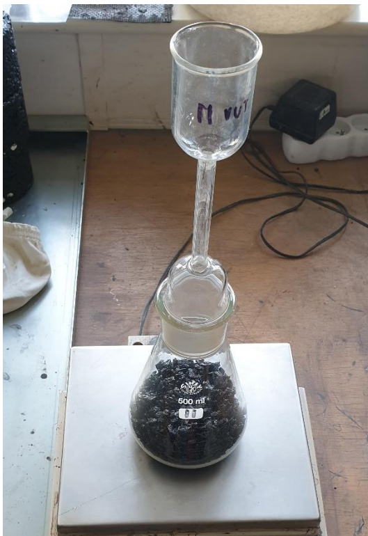
Obrázek 23: Vážení pyknometru se směsí i nástavcem (30)
