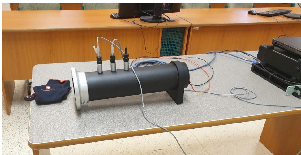
Obrázek 32: Impedanční trubice Brüel & Kjær Type 4206 s připojenými mikrofony a napojená na řídicí jednotku (30)
