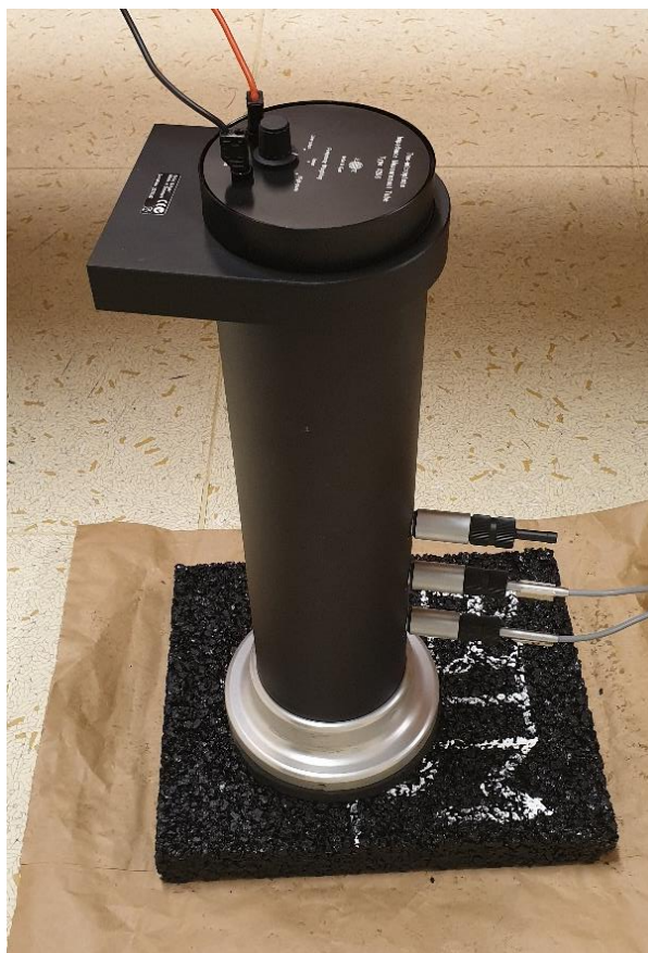
Obrázek 33: Impedanční trubice ve vertikální pozici před měřením (30)
