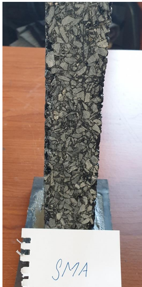
Obrázek 31: Pohled na řez deskou směsi SMA 8 NH (30)
