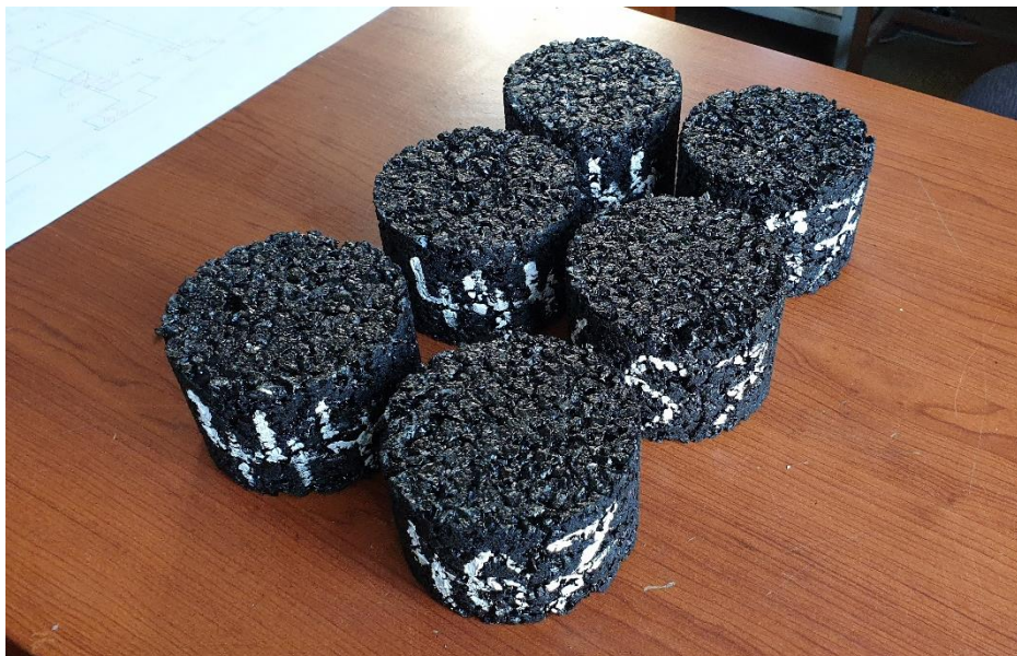
Obrázek 25: Dvě sady Marshallových těles (30)
