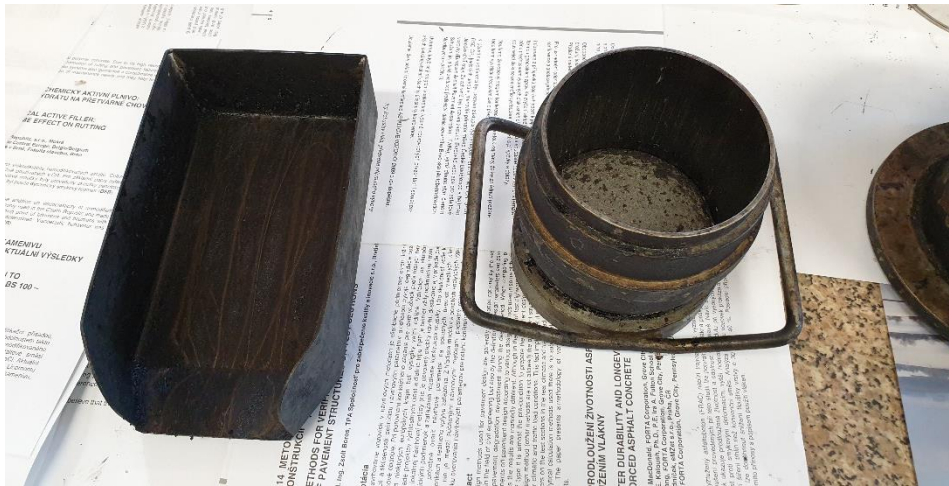
Obrázek 20: Ocelová nádoba na namíchanou směs pro jedno zkušební těleso (vlevo) a forma pro výrobu zkušebního tělesa (vpravo) (30)
