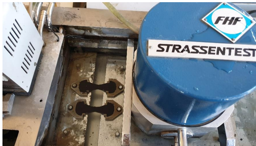
Obrázek 107: Provedení zkoušky vratné duktility 1 (30)
