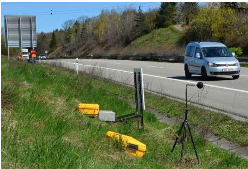
Obrázek 5: Reálná ukázka umístění mikrofonu při statistické metodě při průjezdu (SPB) (12)
