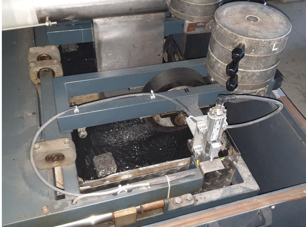
Obrázek 34: Pohled na separační fólii po zkoušce poježdění kolem (30)
