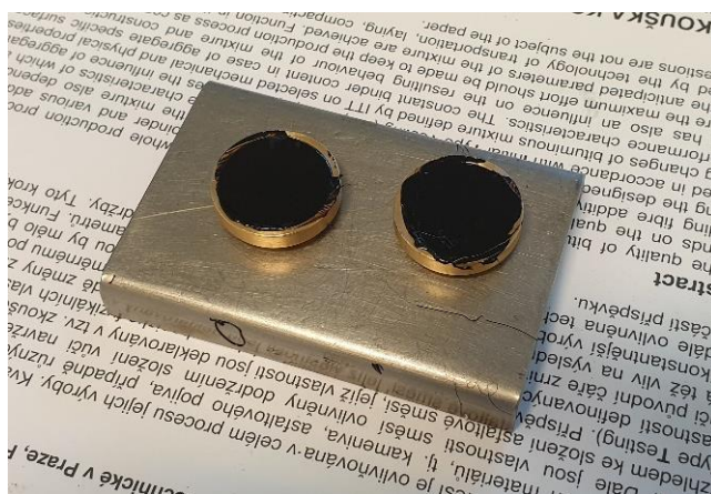
Obrázek 15: Kroužky s odlitým asfaltovým pojivem (30)
