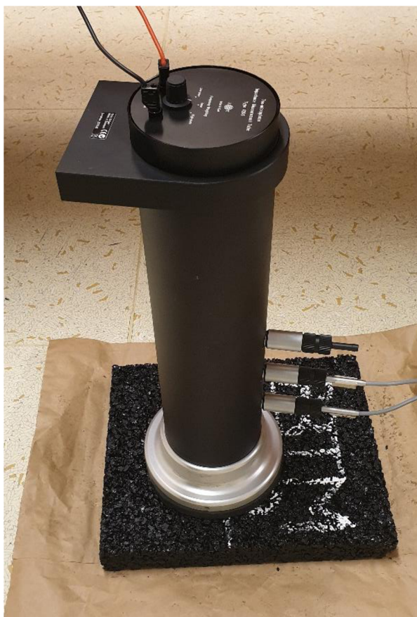
Obrázek 33: Impedanční trubice ve vertikální pozici před měřením (30)
