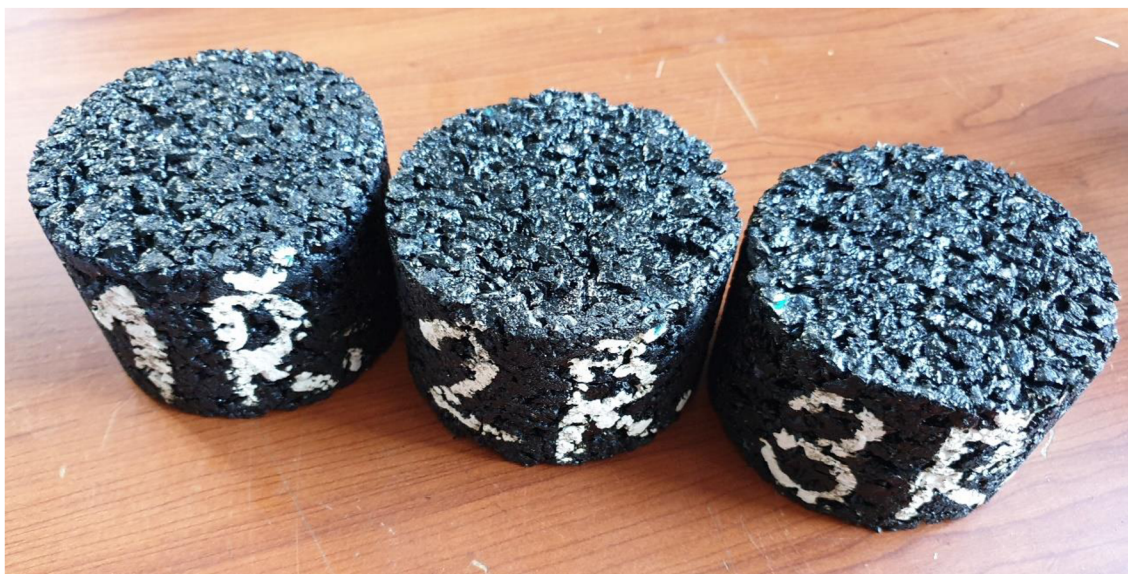
Obrázek 22: Jedna sada Marshallových těles (30)
