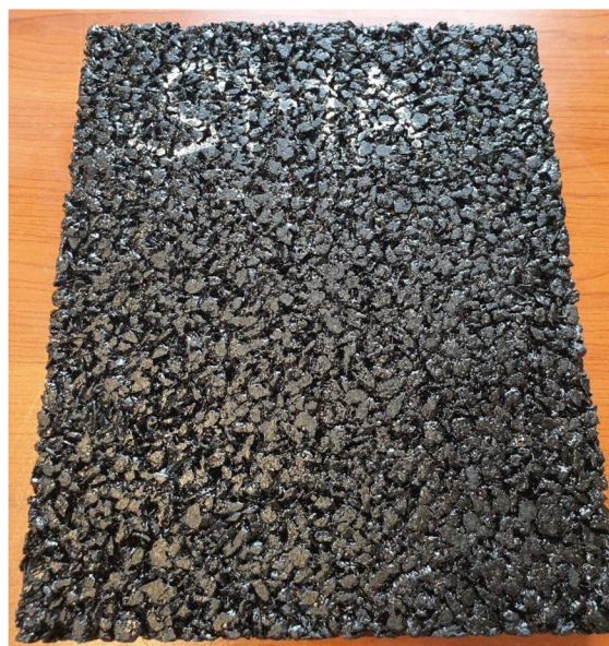
Obrázek 29: Hotová zhutněná deska SMA 8 NH (30)
