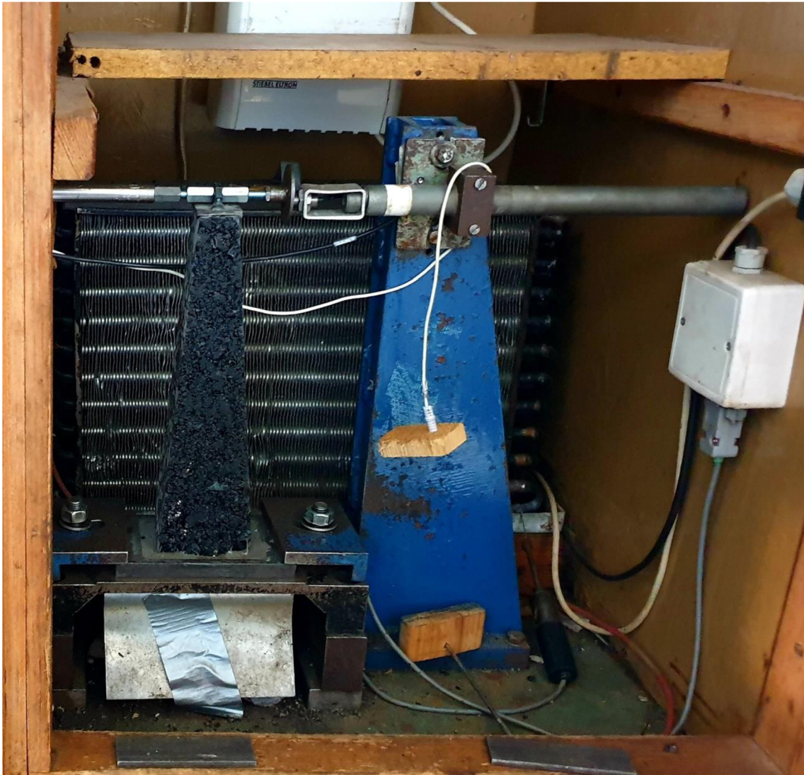
Obrázek 41: Zkušební těleso upevněné ve zkušebním zařízení (30)
