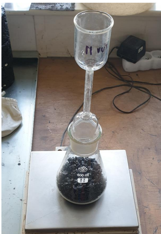
Obrázek 23: Vážení pyknometru se směsí i nástavcem (30)
