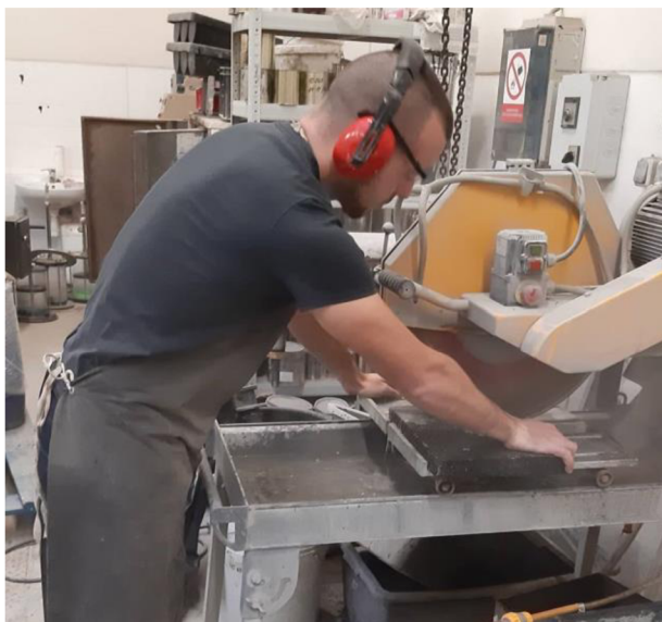
Obrázek 37: Vyřezávání zkušebních těles (30)
