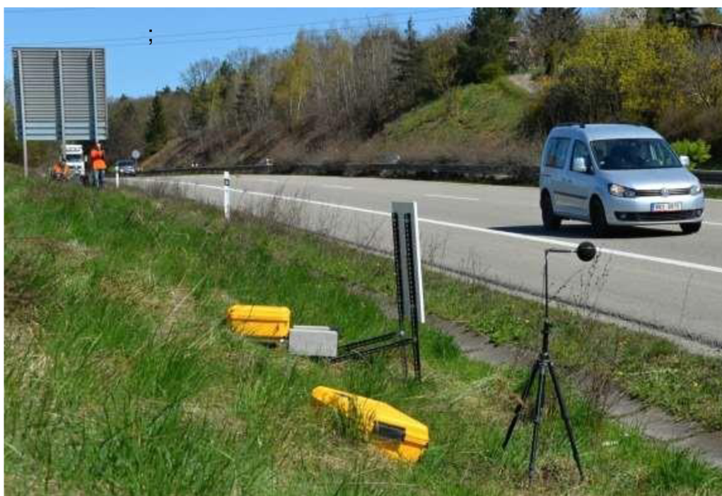
Obrázek 5: Reálná ukázka umístění mikrofonu při statistické metodě při průjezdu (SPB) (12)
