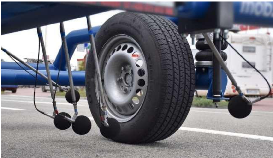
Obrázek 6: Umístění mikrofonů kolem referenční pneumatiky (12)
