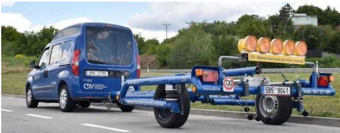
Obrázek 7: Měřicí přívěs CPX (12)
