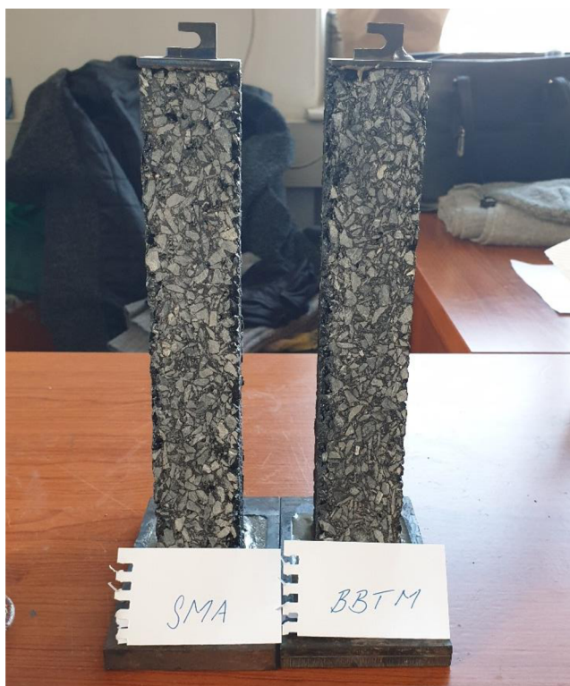
Obrázek 40: Nařezaná a nalepená zkušební tělesa s pohledem na jejich strukturu (30)
