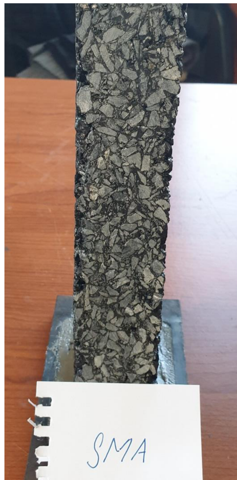
Obrázek 31: Pohled na řez deskou směsi SMA 8 NH (30)
