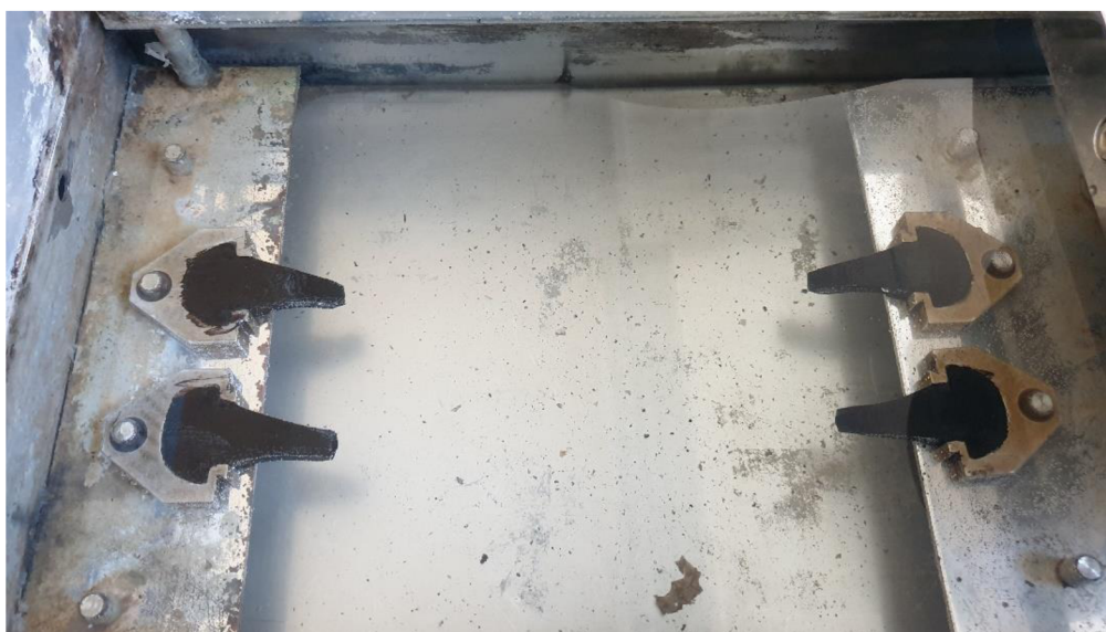
Obrázek 118: Provedení zkoušky vratné duktility 2 (30)
