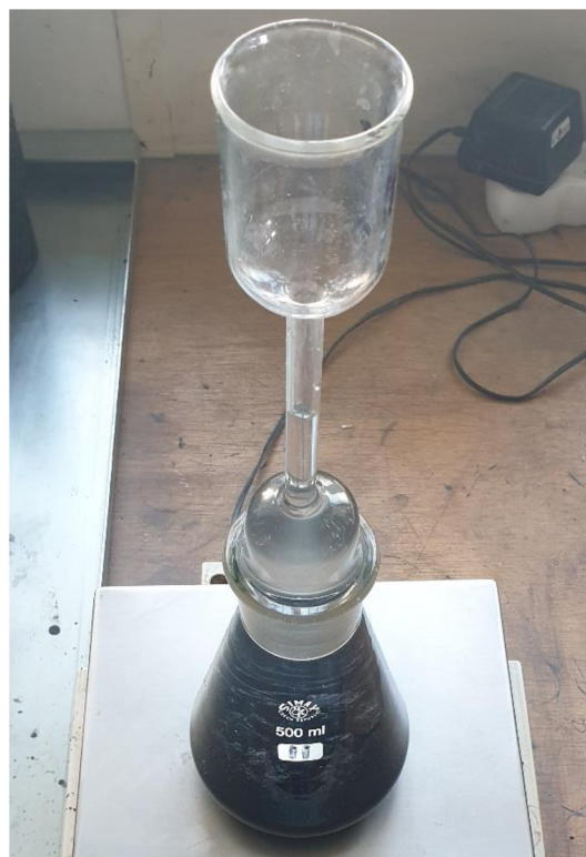
Obrázek 24: Vážení pyknometru se směsí, nástavcem a doplněnou vodou po rysku (30)
