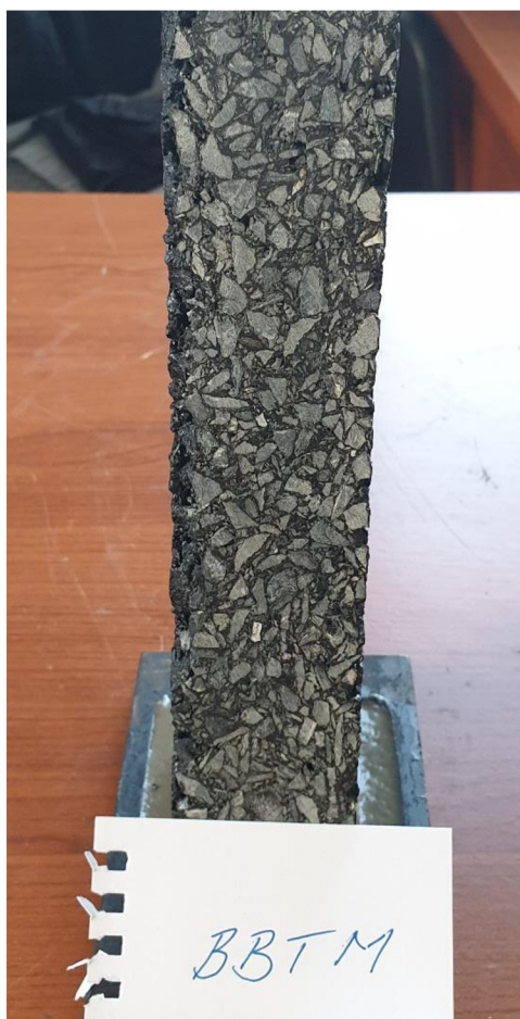
Obrázek 30: Pohled na řez deskou směsi BBTM 8 NH (30)
