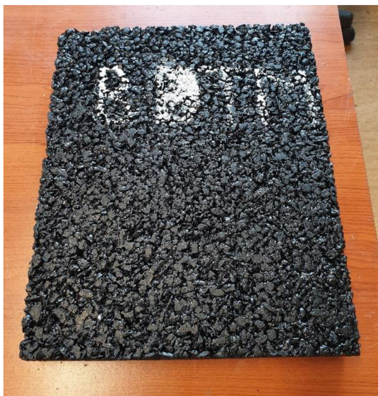
Obrázek 28: Hotová zhutněná deska BBTM 8 NH (30)
