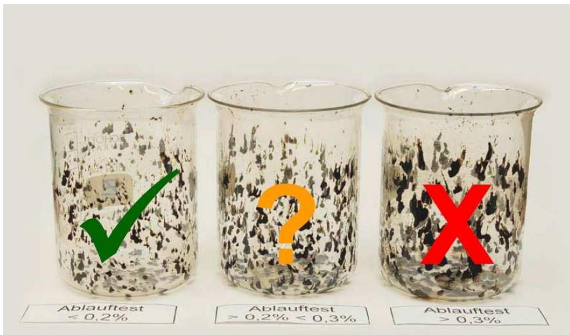
Obrázek 3: Zkouška stékavosti pojiva (8)
