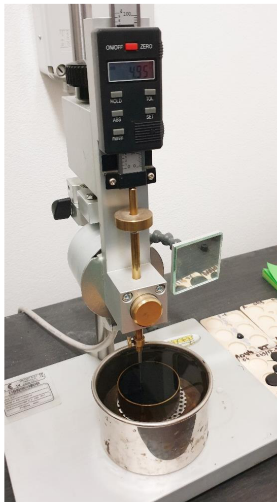
Obrázek 14: Provádění zkoušky penetrace jehlou (30)
