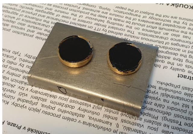
Obrázek 15: Kroužky s odlitým asfaltovým pojivem (30)
