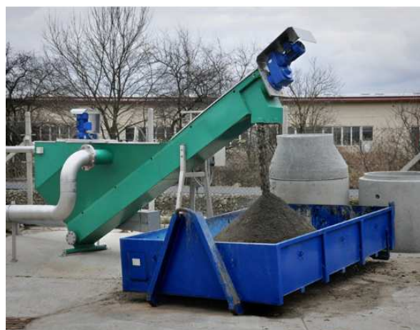
Obr. 4: Příklad separace písku [19]
