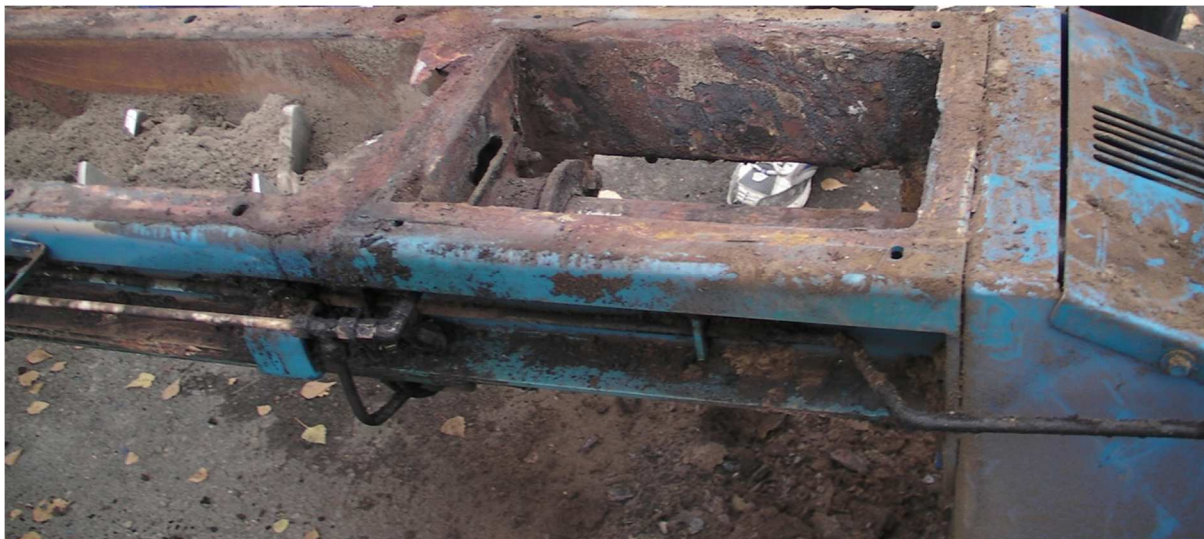
Obr. 5: Špatné navržení typu materiálu
