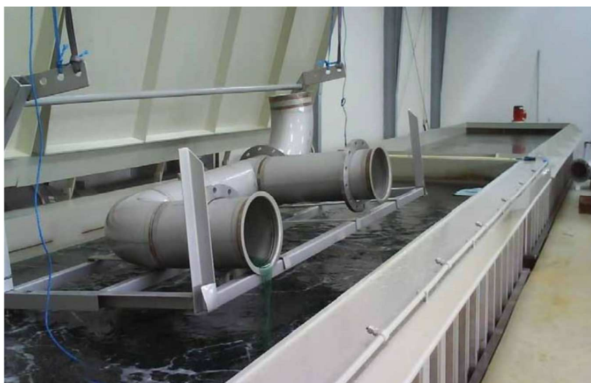
Obr. 16: Moření v lázni [26]
