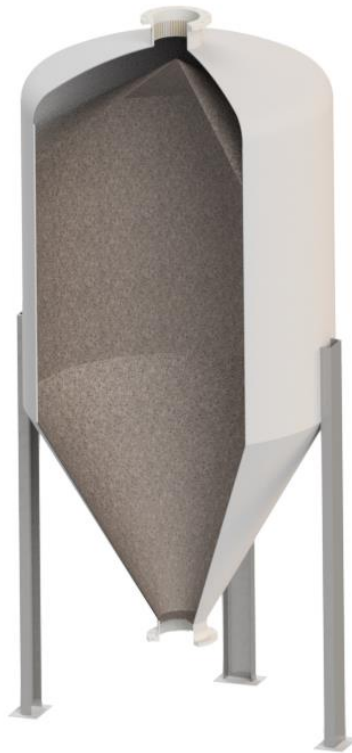
Obr.4.1-1 3D model zásobníku sypkých hmot v plném stavu
