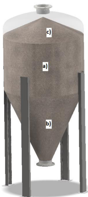
Obr.4.3.2-1 Náplň zásobníku a) válcová část; b) kuželová výsyvka; c) sypný kužel
