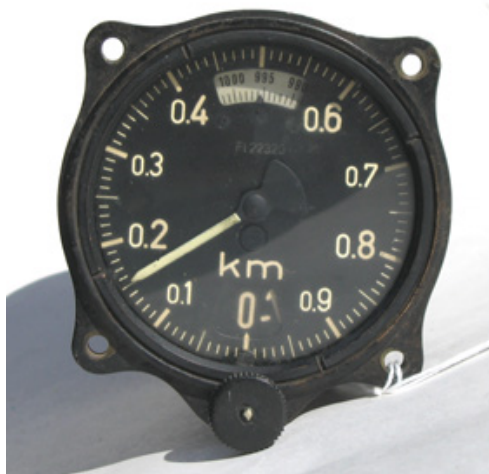
Obrázek 2.4: Výškoměr z letounu Bf109 3
