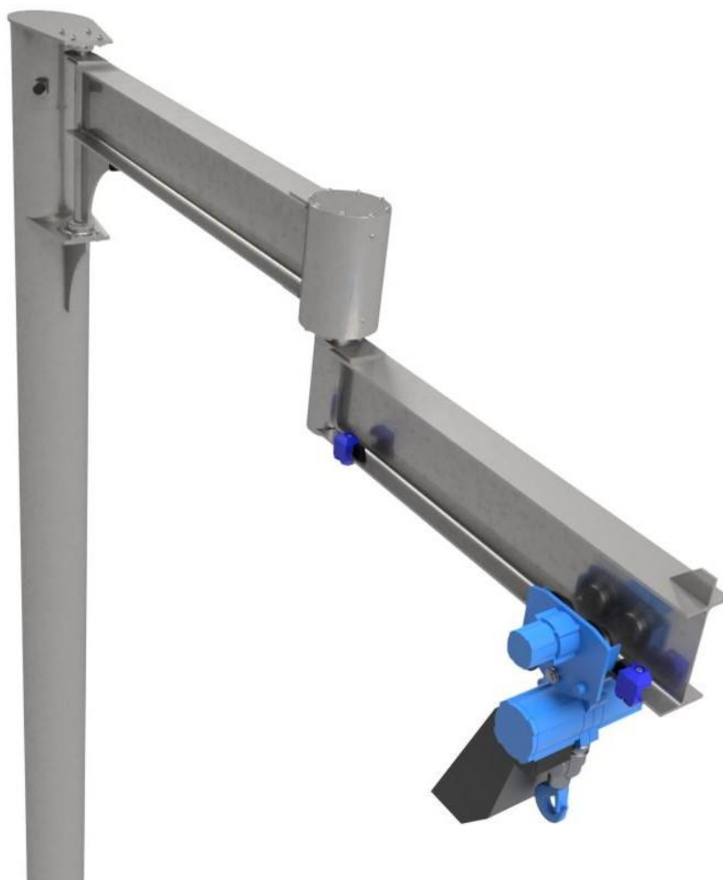
Obr. 6 Koncepce sloupového jeřábu s kloubovým ramenem
