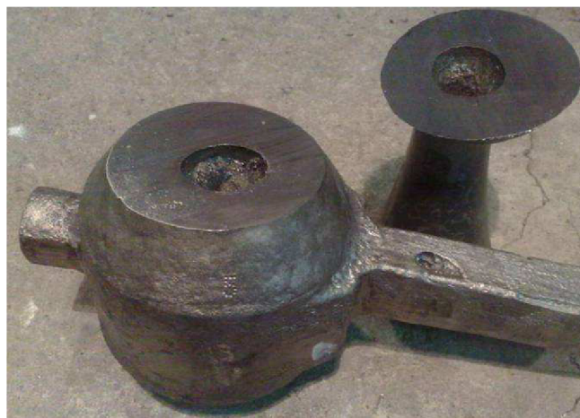
Obr.4.12 Rozříznutá staženina, Technologický odlitek č. 5
