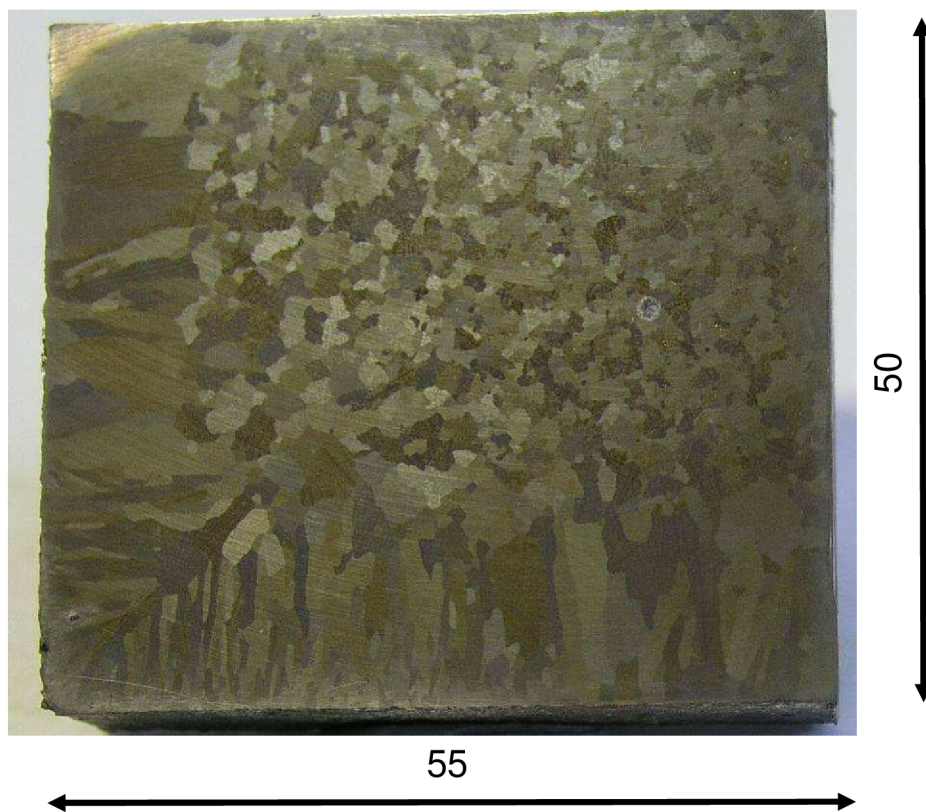
Obr.4.20 Vzorek 2-4 makroskopická struktura oceli 30CH3N17G2L
