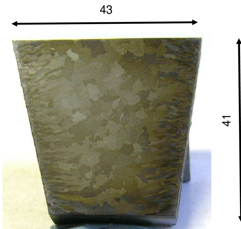
Obr.4.17 Vzorek 2-1 makroskopická struktura oceli 30CH3N17G2L
