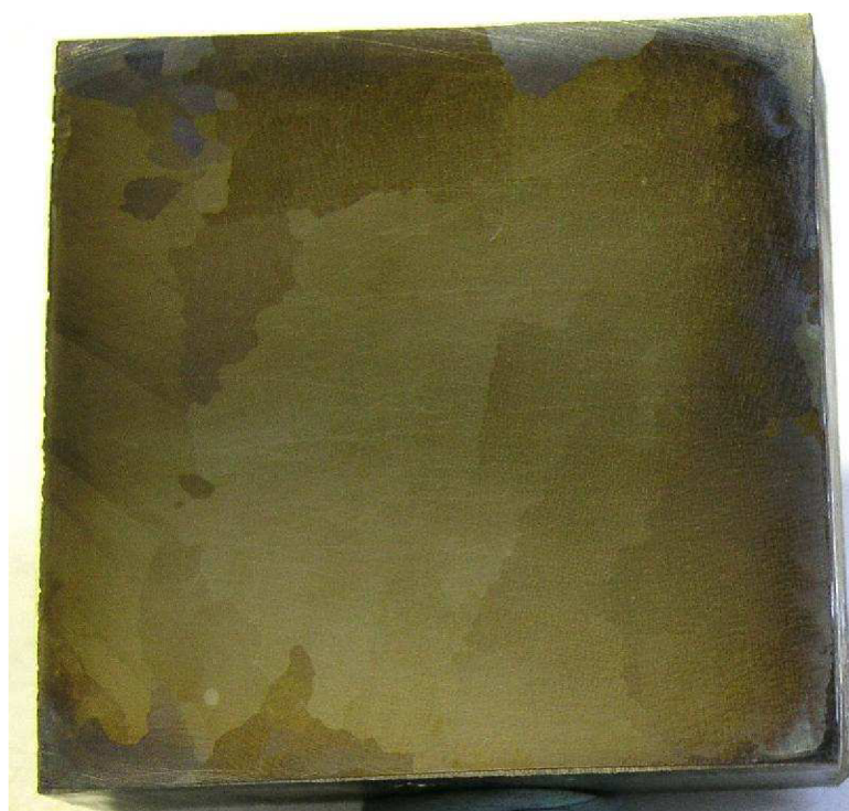
Obr.4.15 Vzorek 1-3 makroskopická struktura oceli 30CH3N17G2L
