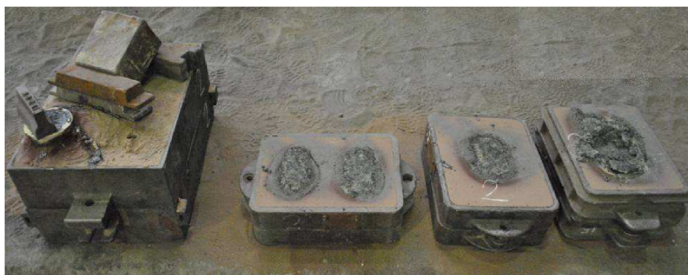
Obr.4.9 Lící pole - odlitá zkušební sada odlitků č.2
