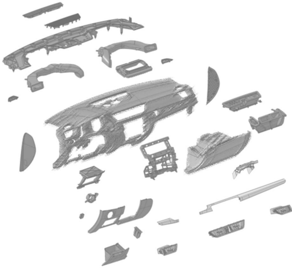
Obrázek 14: Rozpadový obrázek přístrojové desky Zdroj: interní materiály firmy
