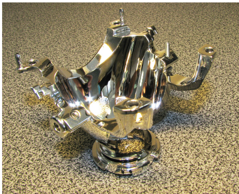
Obrázek 33: Reflektor z formy o drsnosti 27 VDI z kavity 1 zalitý silnou vrstvou laku.
