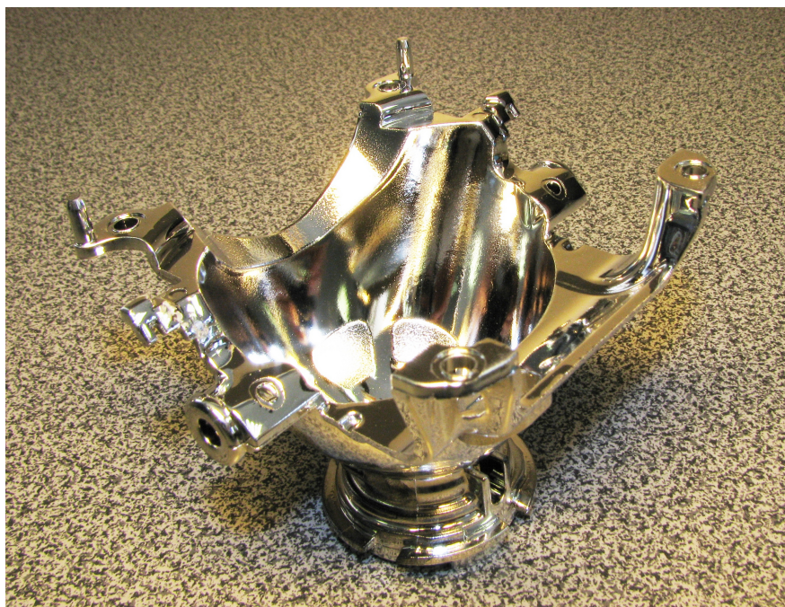
Obrázek 34: Reflektor z formy o drsnosti 27 VDI z kavity 1 zalitý slabší vrstvou laku než na Obrázku 33.
