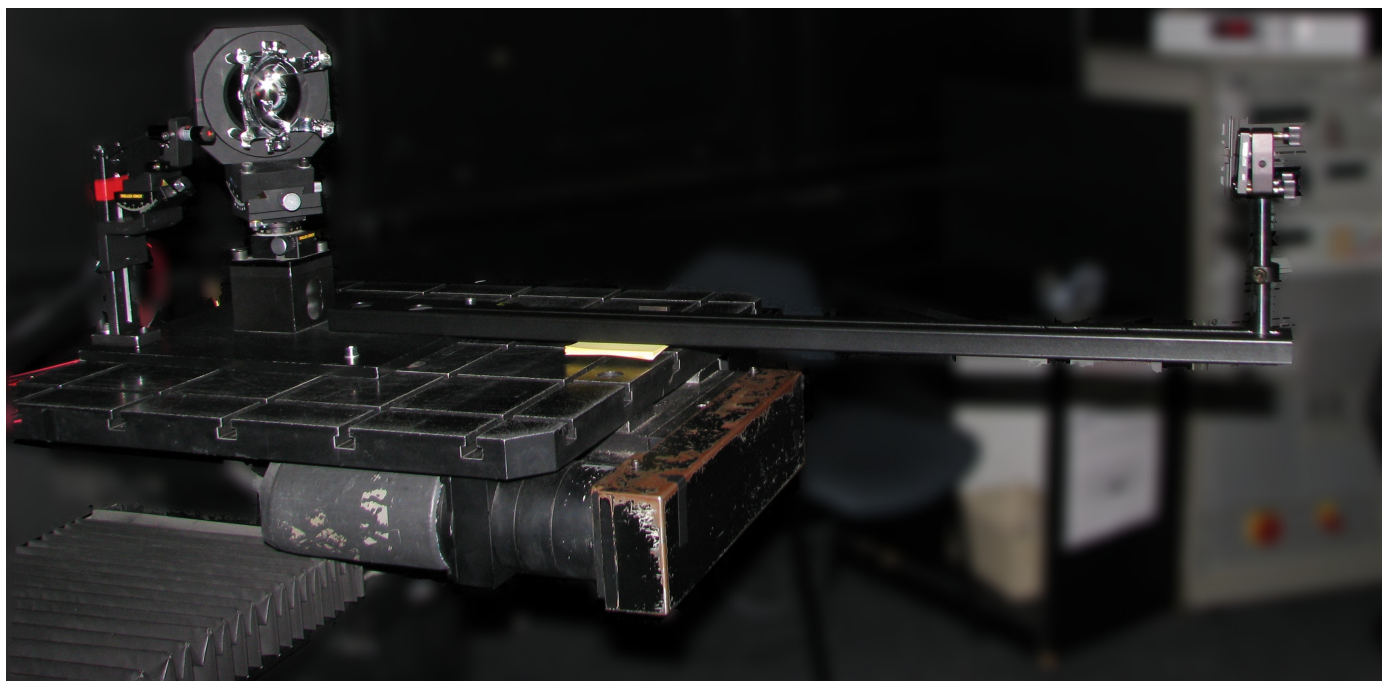
Obrázek 21: Fotografie optické sestavy umístěné na goniometrickém stolku.
