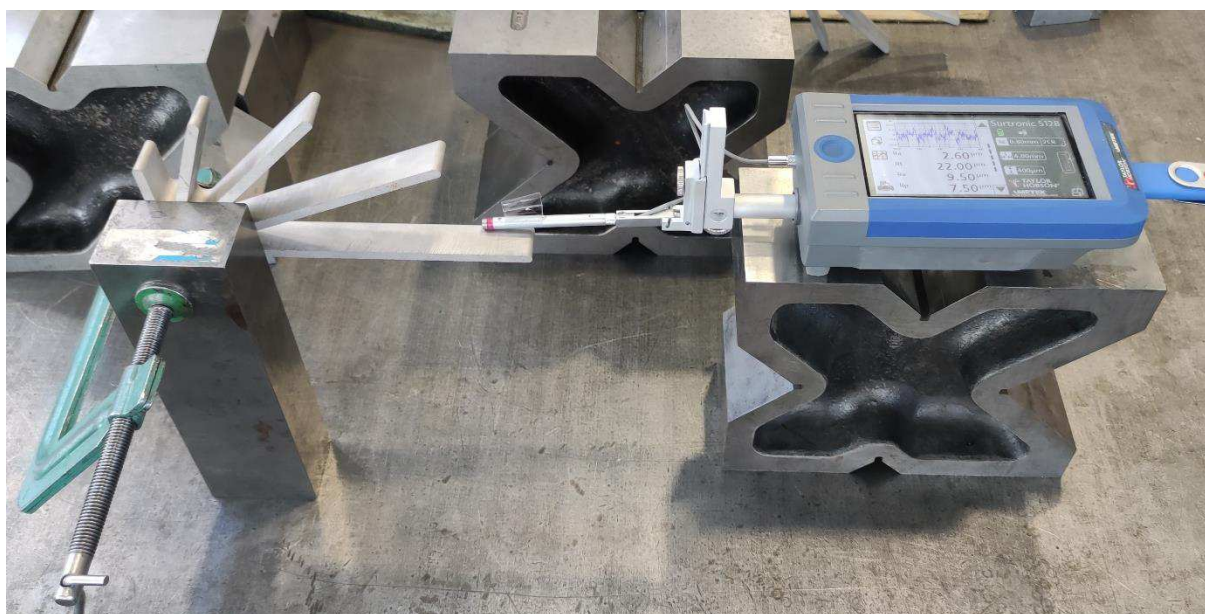
Obr. 47 Měření výběžku „Q1“ v hloubce 2 mm.
