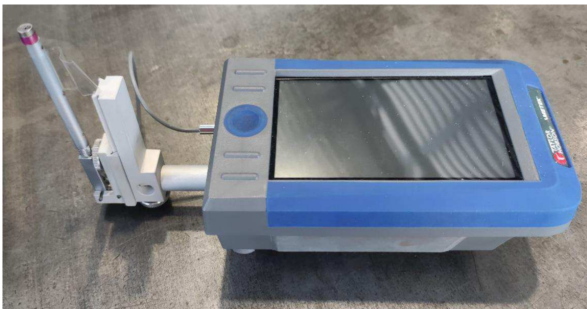
Obr. 44 Drsnoměr Surtronic S-100 od firmy Taylor Hobson.
