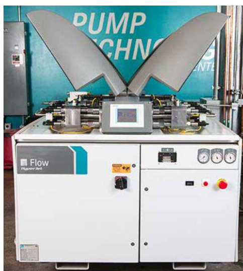
Obr. 38 Vysokotlaké čerpadlo HyperJet [14].
