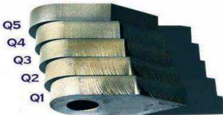
Obr. 11 Jednotlivé stupně jakosti povrchu [12].
