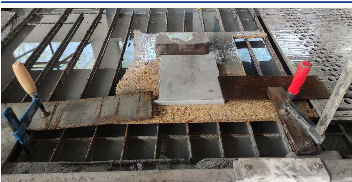
Obr. 43 Upnutí polotovaru na roštu stolu.
