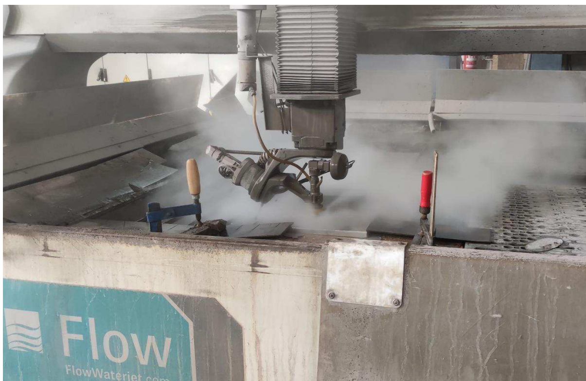
Obr. 42 Vznik mlhového oparu vlivem vnikání paprsku do plného materiálu.
