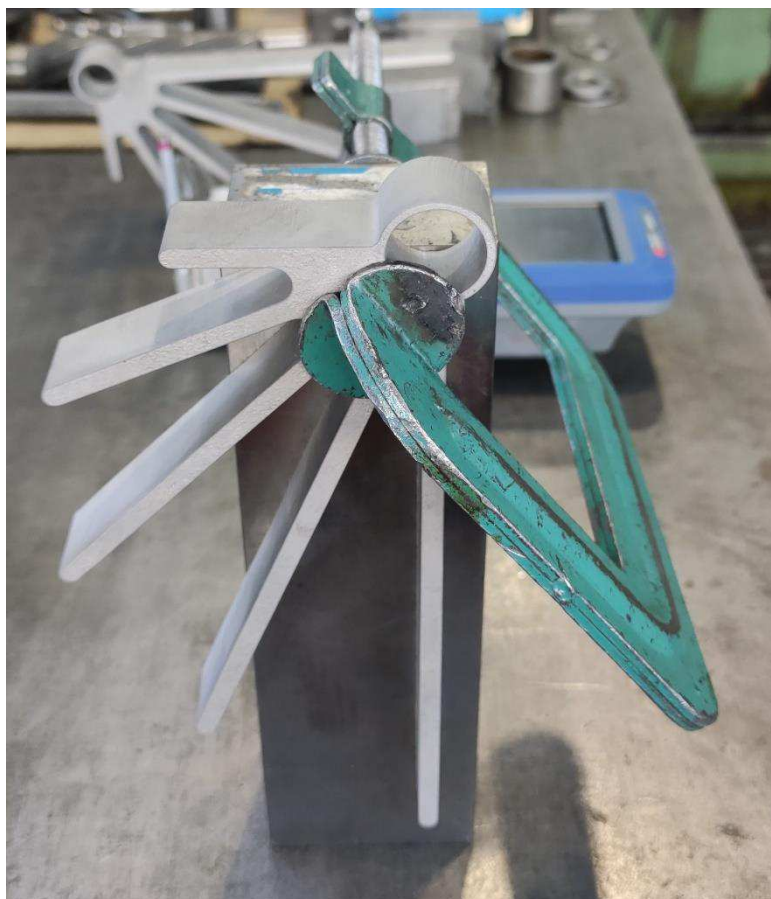
Obr. 46 Upnutí měřené součásti pomocí pákové svěrky.
