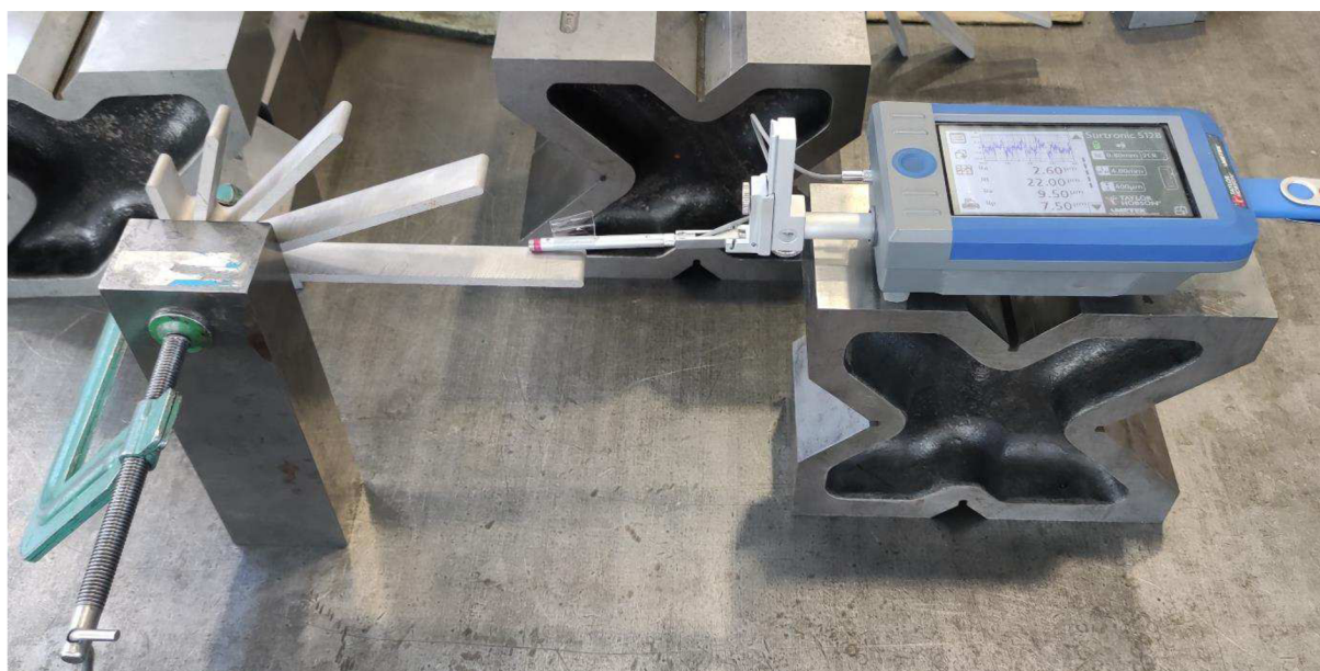
Obr. 47 Měření výběžku „Q1“ v hloubce 2 mm.
