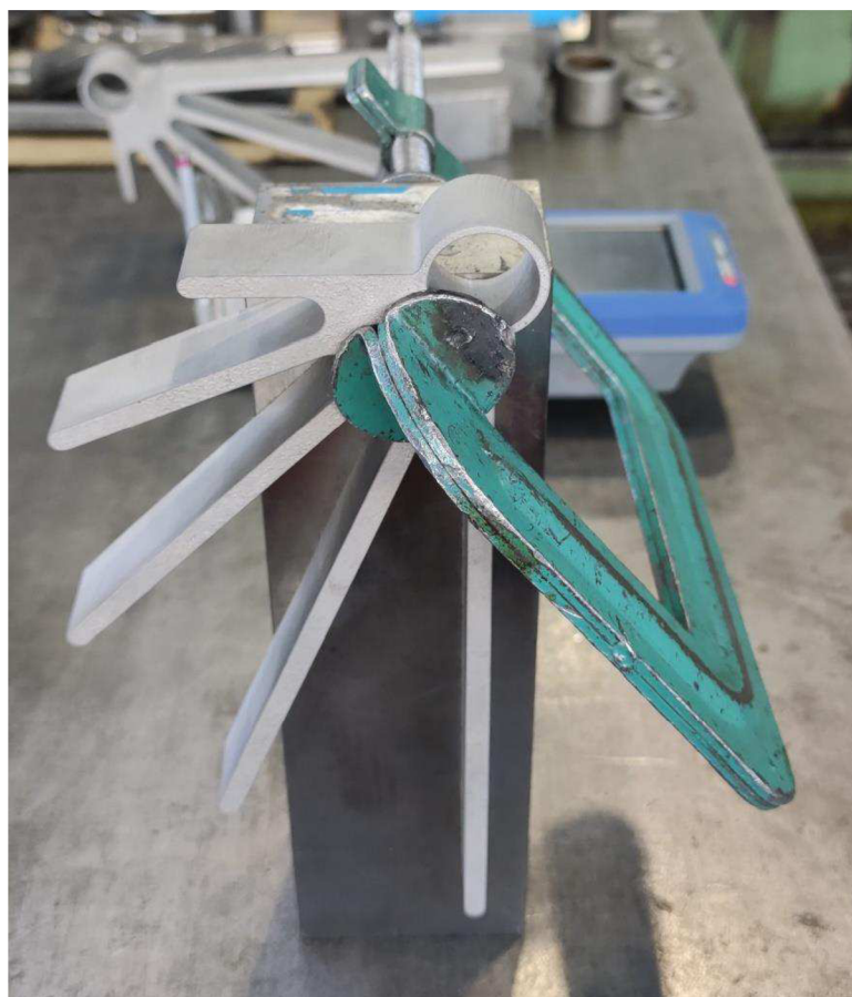
Obr. 46 Upnutí měřené součásti pomocí pákové svěrky.
