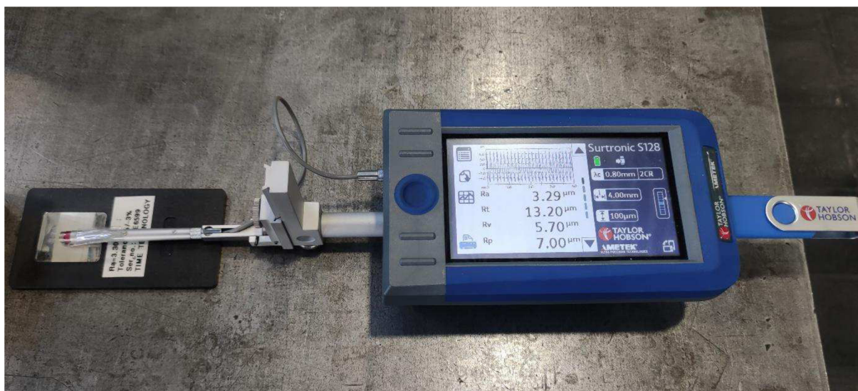
Obr. 45 Kontrolní měření drsnosti etalonu po procesu kalibrace zařízení.
