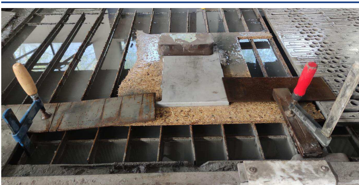
Obr. 43 Uprnutí polotovaru na roštu stolu.
