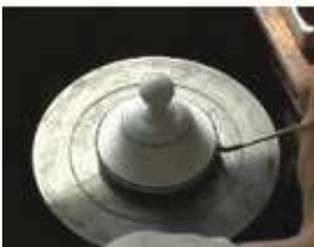
Aujourd'hui la technique de décoration à la main toujours utilisée est l'application du filet or sur les pièces. On dispose l'objet sur une tournette et on applique le filet or au pinceau avec délicatesse. Les pièces passent alors à la troisième cuisson, la cuisson du décor, entre 800 et 900°C.
