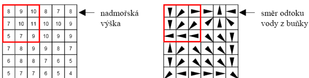
Obr. č. 8 Princip algoritmu směru odtoku (Čejka, 2008)
