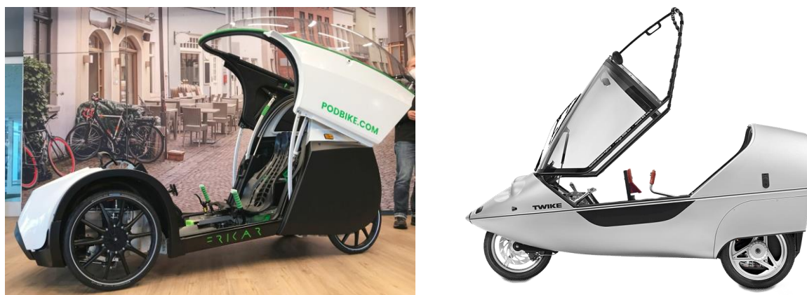
Obr. 13 Možnosti odklopení karoserie [43] [17]
