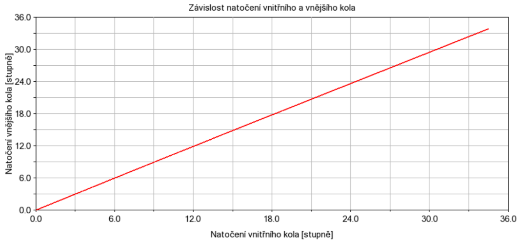
Obr. 40 Závislost natočení vnitřního a vnějšího kola
