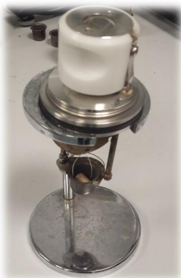
Obr. 4.1.3: Speciální držák s navázanou bavlnkou a zapalovacím adaptérem.
