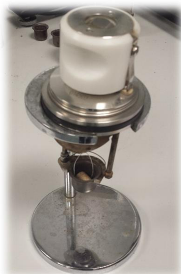
Obr. 4.1.3: Speciální držák s navázanou bavlnkou a zapalovacím adaptérem.
