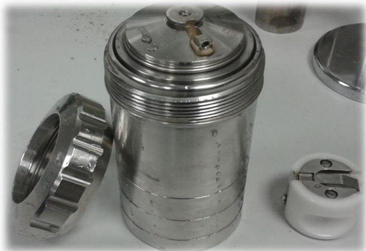
Obr. 4.1.4: Nerezová nádoba s maticí a zapalovacím adaptérem.
