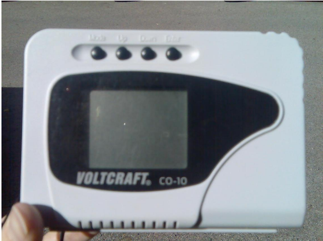
Příloha č.2 – fotografie měřicího přístroje Voltcraft co-10
