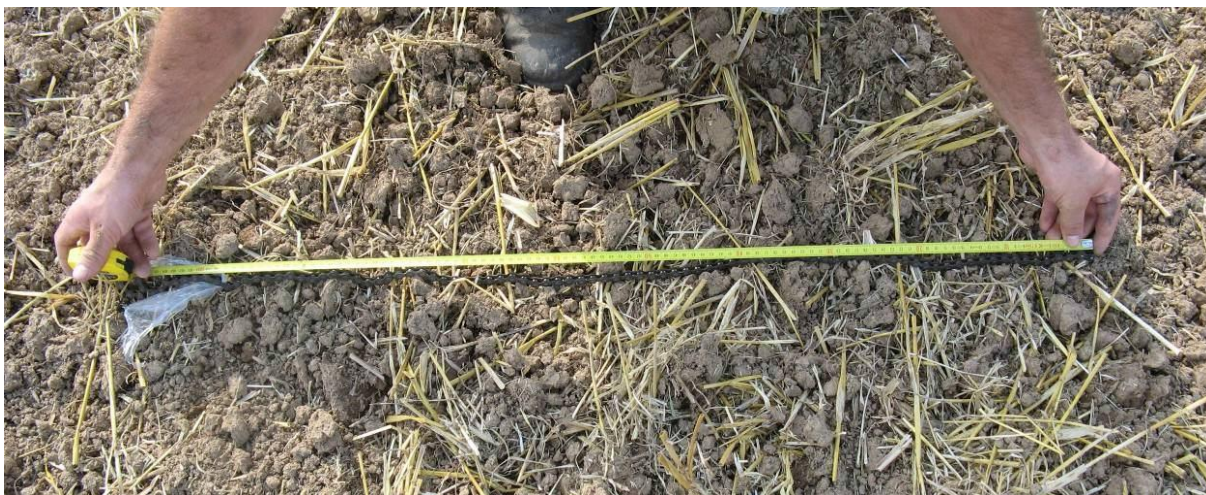
Obr. 21: Zjišťování délky řetězu pro výpočet drsnosti (Autor)
