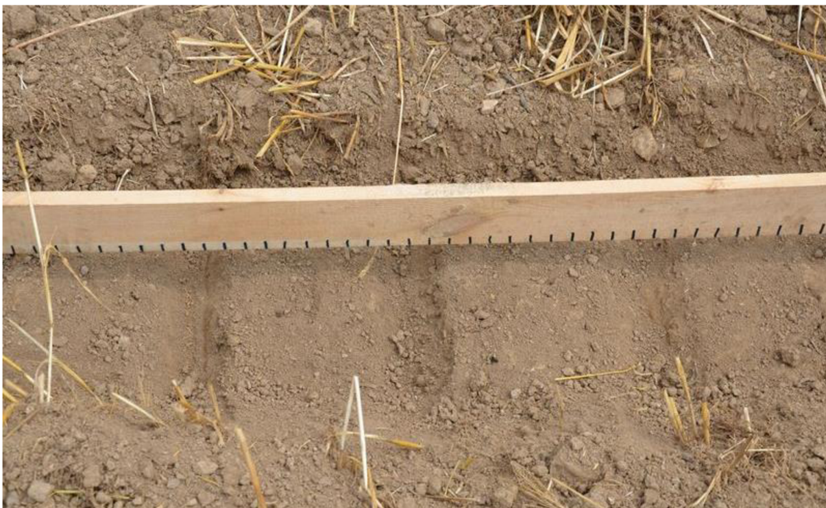
Obr. 22: Měření profilu dna pomocí latě rozměřené po 2,5 cm (Autor)
