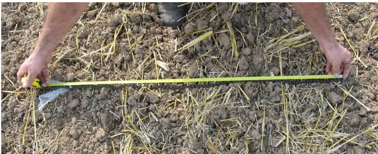
Obr. 21: Zjišťování délky řetězu pro výpočet drsnosti (Autor)
