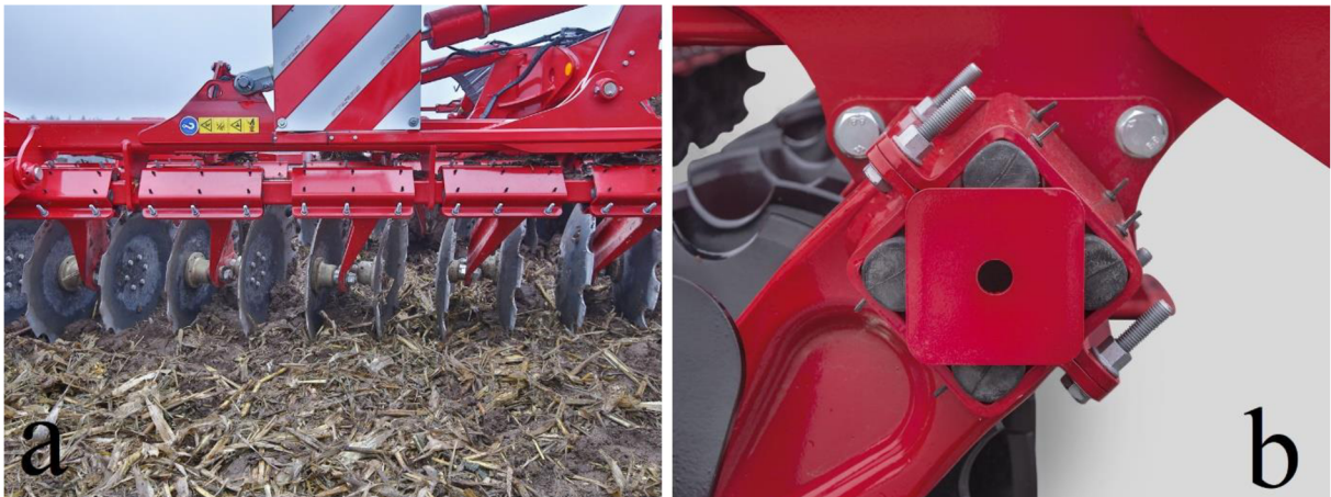
Obr. 10: a – párové uspořádání talířů, b – pryžové uložení slupic (Horsch, 2023)
