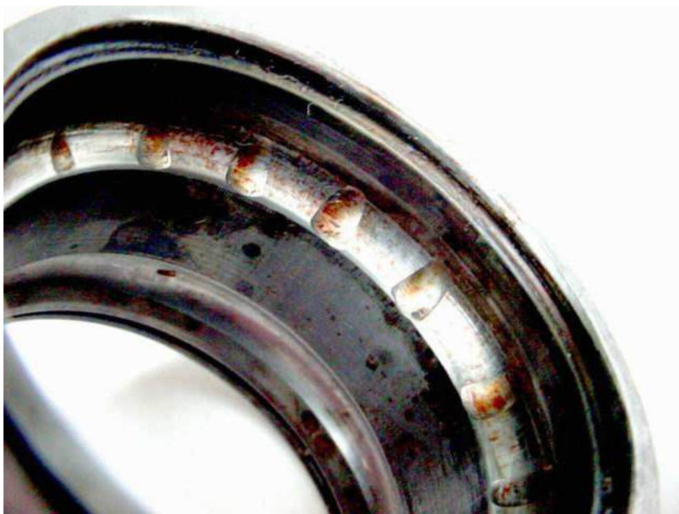
Obr. 18 Vibračně opotřebené pouzdro ložiska
