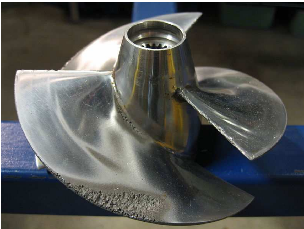
Obr. 12 Kavitačně opotřebená součást
