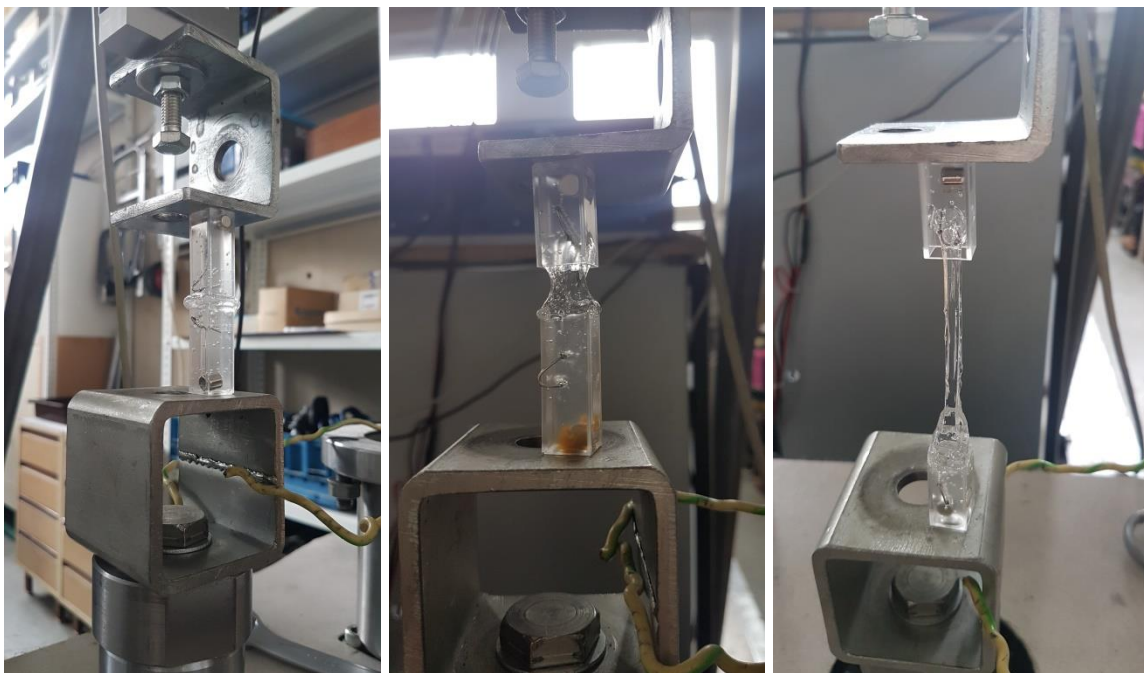
Obrázok 16: ukážka meraní na trhačke Inova CU 31 M08 pre hydrogély na báze PVA
