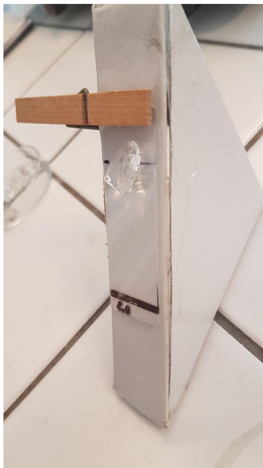
Obrázok 11: adhézne testy na naklonenej rovine 45° u PVA
