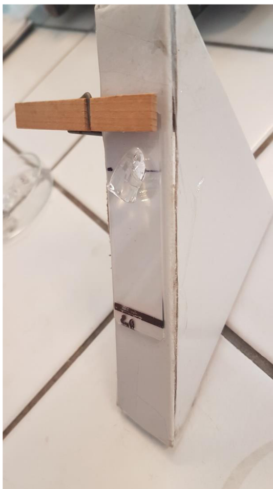
Obrázok 11: adhézne testy na naklonenej rovine 45° u PVA
