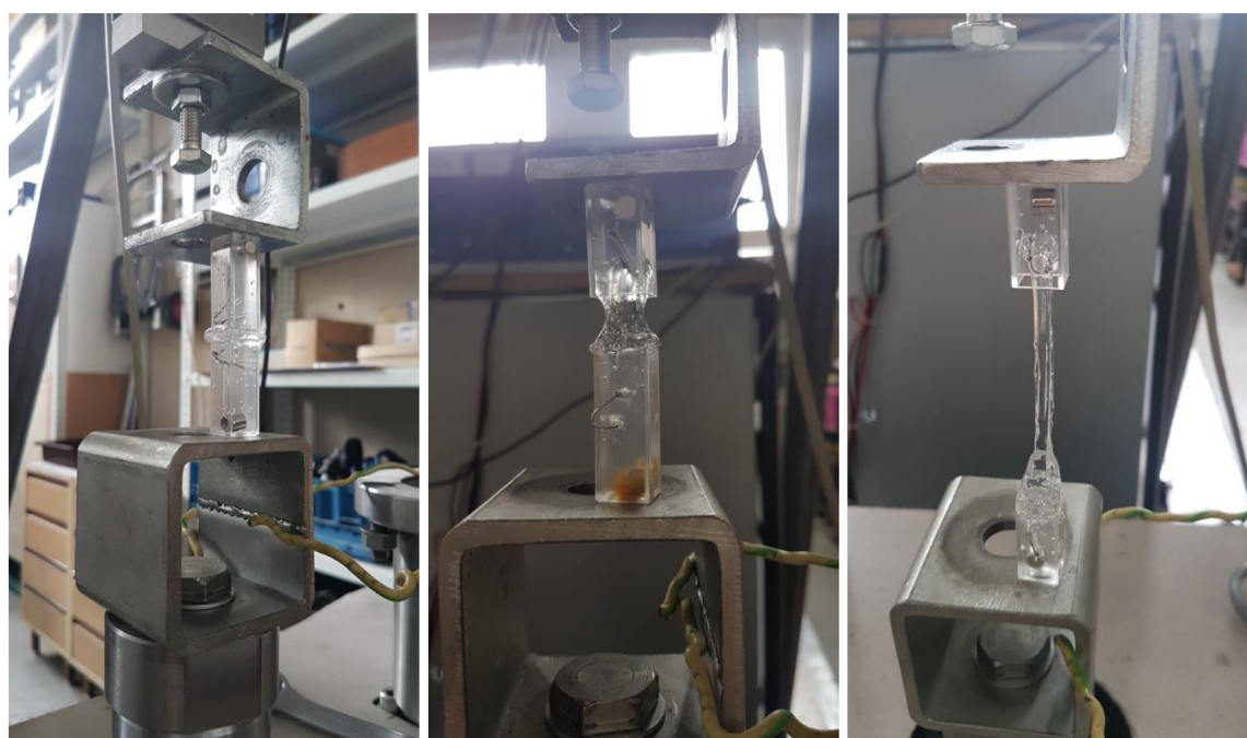
Obrázok 16: ukážka meraní na trhačke Inova CU 31 M08 pre hydrogély na báze PVA
