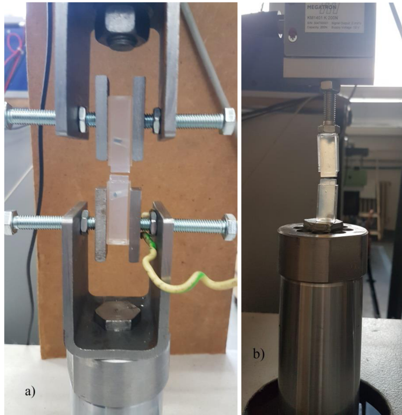
Obrázok 9: Trhačka – Inova – 9a) uchytenie špeciálnym držiakom, 9b) uchytenie neodýmovým magnetom
