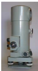
Obr. č. 21 - Přístroj pro přesnou nivelaci od firmy Zeiss Ni 007
