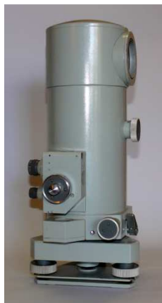
Obr. č. 8 - Přístroj Ni 007 od firmy Zeiss ( http://www.gpprague.cz/cs/index.html )
