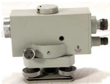
Obr. č. 20 - Přístroj pro technickou nivelaci o firmy Zeiss Ni 025
