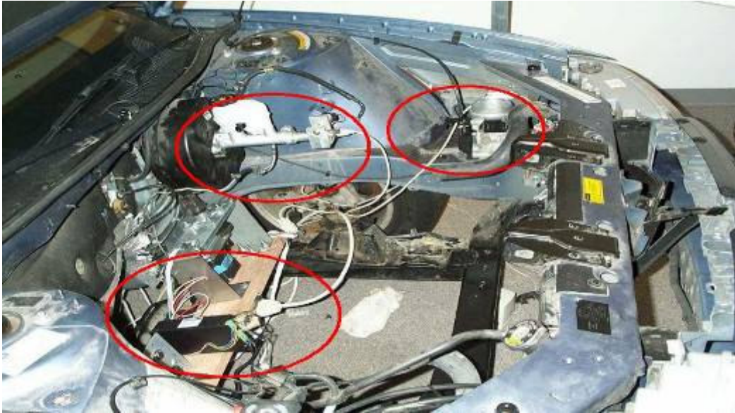
Obrázek 3.3: Detail napojení uživatelského rozhraní simulátoru na senzory [9]
