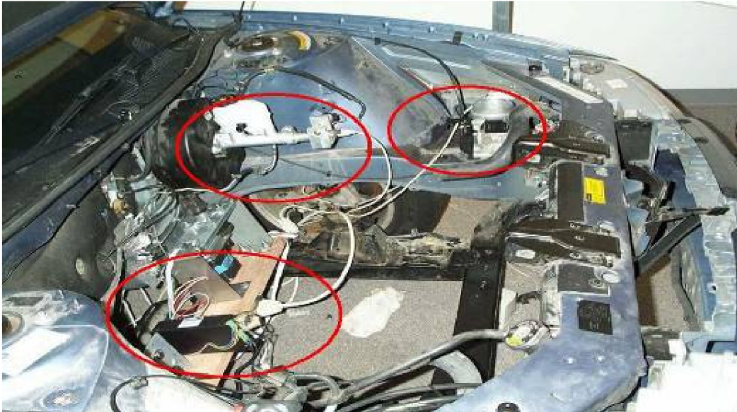
Obrázek 3.3: Detail napojení uživatelského rozhraní simulátoru na senzory [9]
