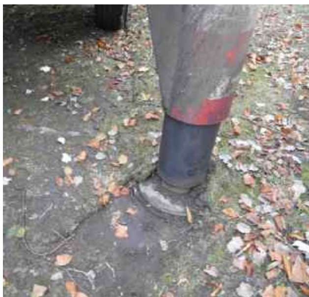
Obr. 28: Detail negativního vlivu PZPP na kořenový systém při nepoužití rozkladových desek
