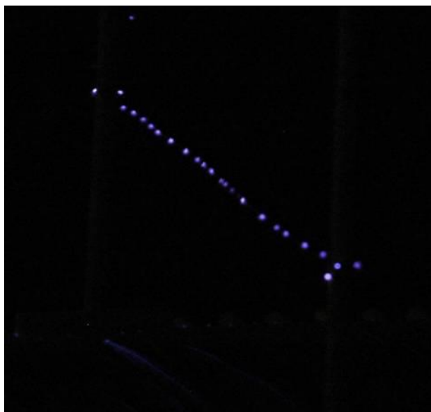
Obrázek 15: Koronový výboj na VN asymetrickém kondenzátoru
