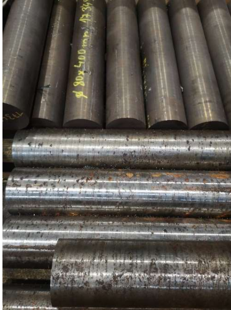
Obr. 11 Polotovary (níže ocel ČSN 14 109, výše ocel ČSN 17 349).
