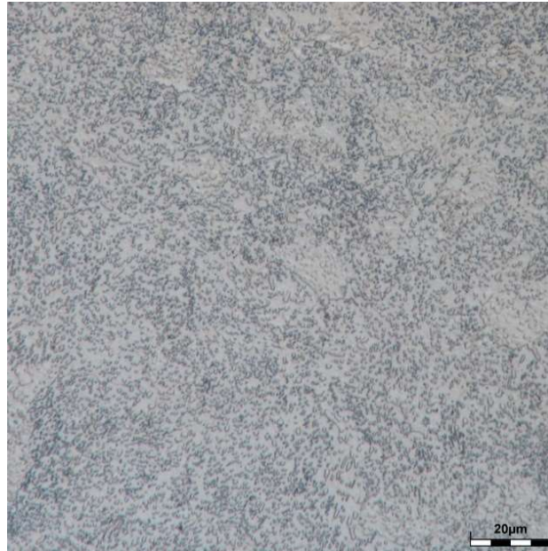
Obr. 83 Snímek mikrostruktury (mat. ČSN 14 109, vzorek 1).
