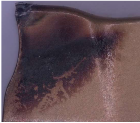
Obr. 37 Destička A2 po 10 minutách (VH).
