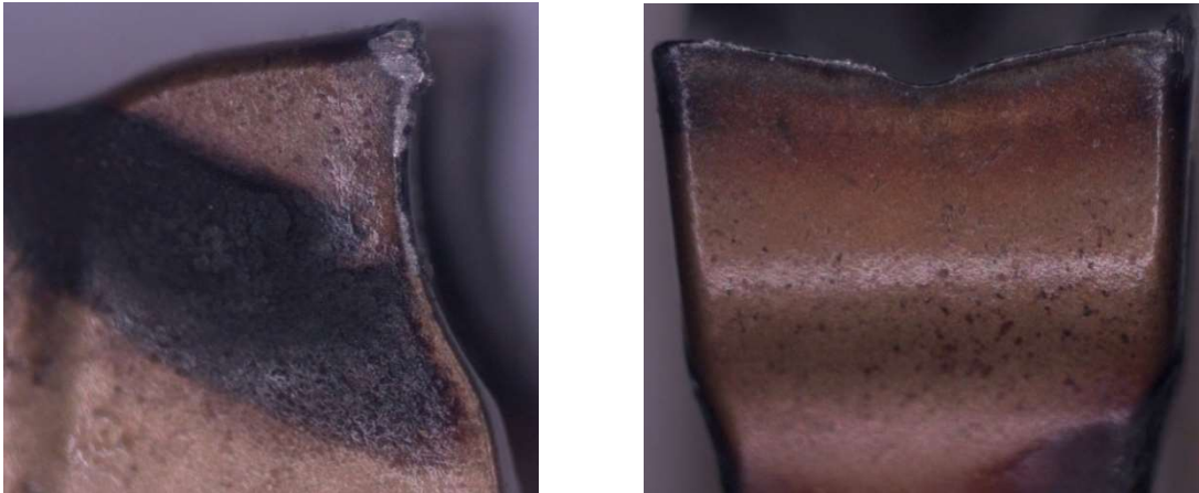
Obr. 61 Destička A2 po 20,4 minutách (HH). Obr. 62 Destička A2 po 20,4 minutách (HH).
