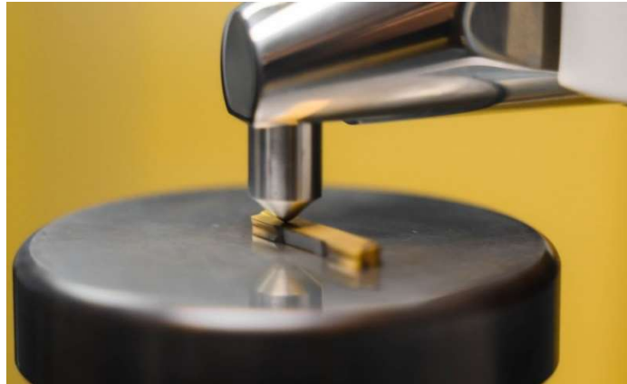
Obr. 90 Vyhotovení vtisku na tvrdoměru ZHR 4150AK.
