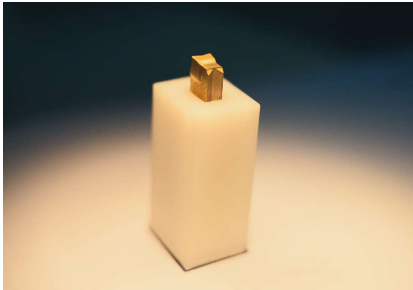
Obr. 23 Hotový přípravek s VBD pod mikroskopem.
