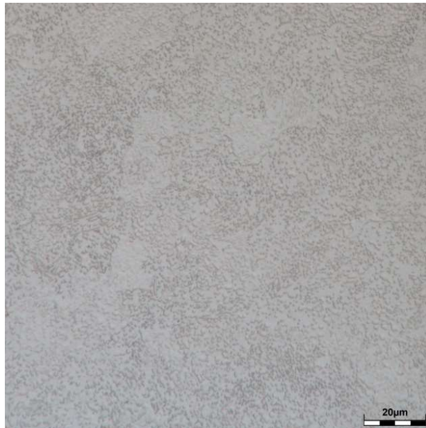
Obr. 84 Snímek mikrostruktury (mat. ČSN 14 109, vzorek 2).
