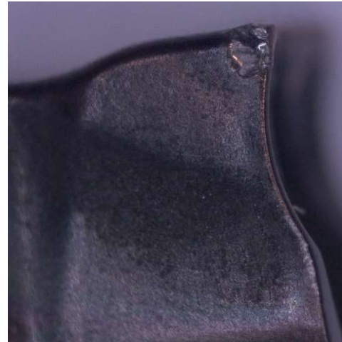
Obr. 49 Destička C1 po 16 minutách (HH). Obr. 50 Destička C1 po 16 minutách (VH2).
