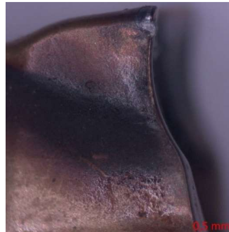
Obr. 35 Destička A1 po 12 minutách (VH2).
