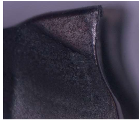
Obr. 65 Destička B1 po 25,5 minutách (HH). Obr. 66 Destička B2 po 25,5 minutách (VH2).
