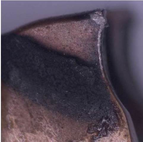
Obr. 58 Destička A1 po 20,4 minutách (VH2). Obr. 59 Destička A1 po 20,4 minutách (HH).
