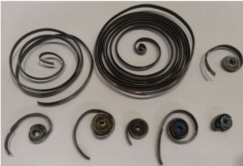
Obr. 26 Spektrum třísek získaných obráběním.
